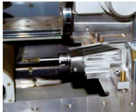
Husillo de rotación totalmente integrado en el mando de la máquina con posicionamiento para los componentes de alta precisión más pequeños, p. ej.: Fabricación de clavijas expulsoras con diámetro  $\geq 0,05$  mm, realización de rosca cónica en aplicaciones médicas, rectificado y torneado erosivo, mecanizado simultáneo.
