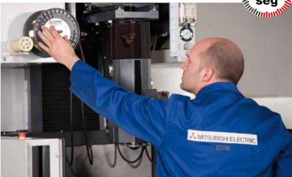
Simplemente se cambia la bobina y se guía el hilo de electroerosión sobre los rodillos de transporte. Todo preparado de nuevo para trabajar en 92 segundos.
