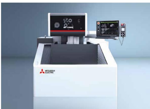
El modo de ajuste, la programación, el mantenimiento, etc. Se puede acceder a todos los elementos esenciales directamente desde la parte frontal de la máquina. Debido al diseño abierto y la puerta corredera vertical automática, el hilo completo, el enhebrado automático, los cabezales de guía de hilo y toda el área de trabajo son muy accesibles.
