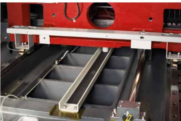
¿Con qué no estaban de acuerdo los diseñadores de Mitsubishi Electric de los sistemas de accionamiento convencionales? La necesidad de lubricación, la fricción y el calor de fricción, el consumo de electricidad, el juego de inversión, momento de torsión y, principalmente, el posible desgaste. Solo un accionamiento sin contacto puede evitar estos inconvenientes desde el principio y, de este modo, es la garantía de unos mejores resultados y mayor fiabilidad durante décadas.
