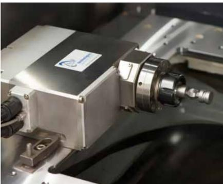
Un eje B con servo, totalmente integrado en el control de la máquina, que le permite la electroerosión por hilo en la pieza de trabajo girando. De este modo pueden realizarse los mecanizados de separación y de múltiples lados en una sujeción, así como mecanizados simultáneos.
