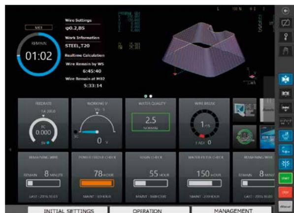
La presentación de todos los parámetros de edición esenciales en forma configurable es fácil de entender y ayuda a mantener el control en todo momento. Cuando lo desee y de un solo vistazo, usted puede acceder al estado del programa, tiempos de proceso, el estado del mantenimiento así como otras informaciones. La configuración tiene lugar de una manera sencilla.
