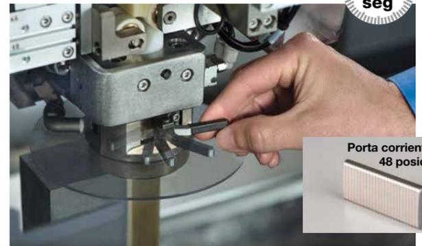
Cambiar el contacto eléctrico solo con la mano y un pequeño auxiliar de medición – a la velocidad de un fórmula 1.
