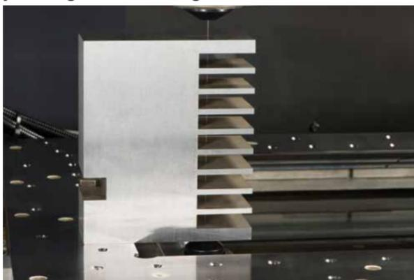
La máquina no vuelve a la posición de inicio, en lugar de eso, continúa recto, gracias al avanzado procesamiento térmico del hilo. Dependiendo de las condiciones de mecanizado, el enhebrado puede realizarse con o sin guía de chorro de agua y también en el baño de dieléctrico de acuerdo con la altura de la pieza.
