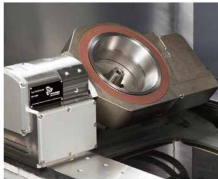
Para el mecanizado de elementos cónicos con los máximos requisitos de precisión: el eje giratorio/oscilante integrado en el mando de la máquina. Mecanizado multi-eje hasta el centro de la pieza de trabajo y mecanizado de múltiples lados en una sujeción, realización de polígonos cónicos de alta precisión.
