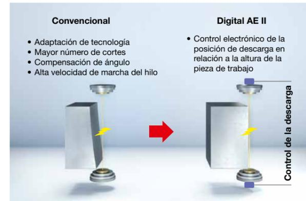
Mediante el control preciso de la posición de descarga solo se erosiona donde es necesario. La función patentada de la Digital AE II le proporciona ventajas para el mecanizado de desbaste, repasos y acabado fino, tanto respecto a la precisión como al tiempo de mecanizado.
