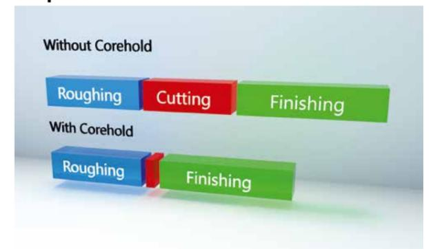
Al desbastar, la máquina de erosión separa el material útil del deshecho, y después del corte une de nuevo ambas partes mediante uno o más pequeños puntos de micro-soldadura. A continuación, las piezas de deshecho se pueden retirar de la pieza de trabajo. Después, el programa de mecanizado puede continuar. Así el tiempo que la máquina está en marcha se reduce de manera significativa.
