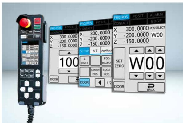
El Mando manual con un diseño inteligente y ergonómico reúne todas las funciones indispensables para el Mando manual. El usuario puede configurar él mismo la pantalla LCD. La máquina cuenta con teclas para mover los ocho posibles ejes CNC.
