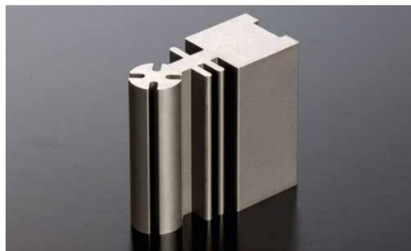
Cuatro cortes con Ra 0,28µm en comparación con la máquina convencional.
