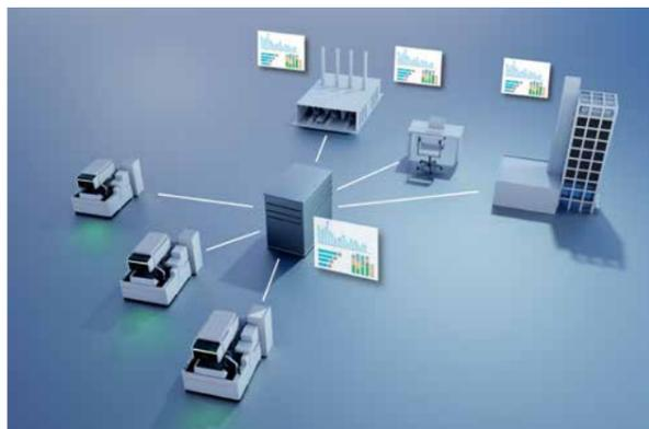
El control puede recuperar los datos de operación y procesamiento. La función de exportación de todos los datos de procesamiento, estados operativos, datos de consumo y condiciones de mantenimiento, así como los mensajes de alarma, está siempre disponible. Así, es posible visualizar y evaluar los datos de máquinas diferentes, incluso hasta integrarlos en sistemas de gestión de producción superiores.
