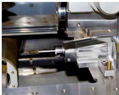
Полностью интегрированный в систему управления станка вращающийся шпиндель с системой позиционирования для мельчайших высокоточных деталей, напр.: производство штифтов выталкивателя диаметром  $\geq 0,05$  мм, реализация конической резьбы в медицинской технике, электроэррозионное шлифование и токарная обработка, одновременная обработка.
