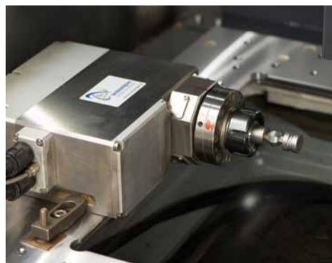
Полностью интегрированная в систему управления ось В с сервоуправлением обеспечивает обработку электродом-проволокой на вращающейся, синхронно подаваемой заготовке. Это позволяет выполнять деление и многостороннюю обработку в одном зажиме, а также проводить одновременную обработку.
