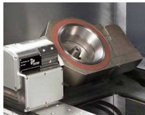
Для обработки конусов с максимальными требованиями к точности: интегрированная в систему управления станком ось вращения/качения. Многоосная обработка вплоть до центра заготовки и многосторонняя обработка в зажиме, реализация высокоточных конических многоугольников.
