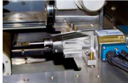
Husillo de rotación totalmente integrado en el mando de la máquina con posicionamiento para los componentes de alta precisión más pequeños, p. ej.: Fabricación de clavijas expulsoras con diámetro  $\geq 0,05$  mm, realización de rosca cónica en aplicaciones médicas, rectificado y torneado erosivo, mecanizado simultáneo.
