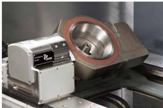
Para el mecanizado de elementos cónicos con los máximos requisitos de precisión: el eje giratorio/oscilante integrado en el mando de la máquina. Mecanizado multi-eje hasta el centro de la pieza de trabajo y mecanizado de múltiples lados en una sujeción, realización de polígonos cónicos de alta precisión.
