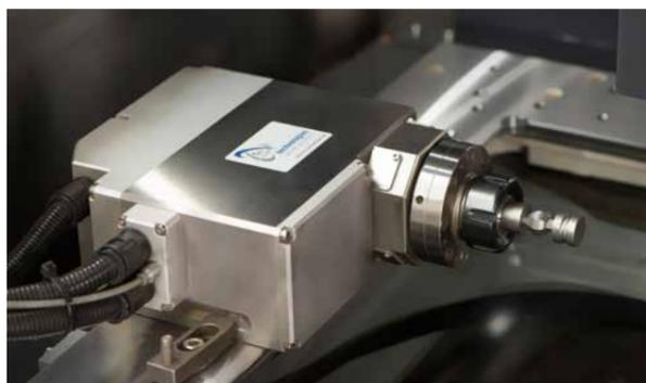
Un asse B servocomandato, completamente integrato nei comandi della macchina, consente di tagliare a filo il pezzo in rotazione. In questo modo è possibile eseguire lavorazioni di divisione e di sfaccettatura con un unico bloccaggio nonché lavorazioni simultanee.
