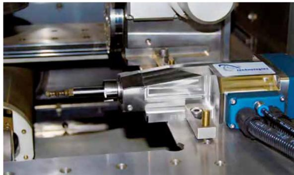
Mandrino rotante, a sua volta completamente integrato nei comandi della macchina, con posizionamento per i componenti più piccoli e precisi, ad es.: produzione di perni espulsori con diametro  $\geq 0,05$  mm, realizzazione di filettature coniche nel campo della tecnica medica, rettifica e tornitura a erosione, lavorazioni simultanee.
