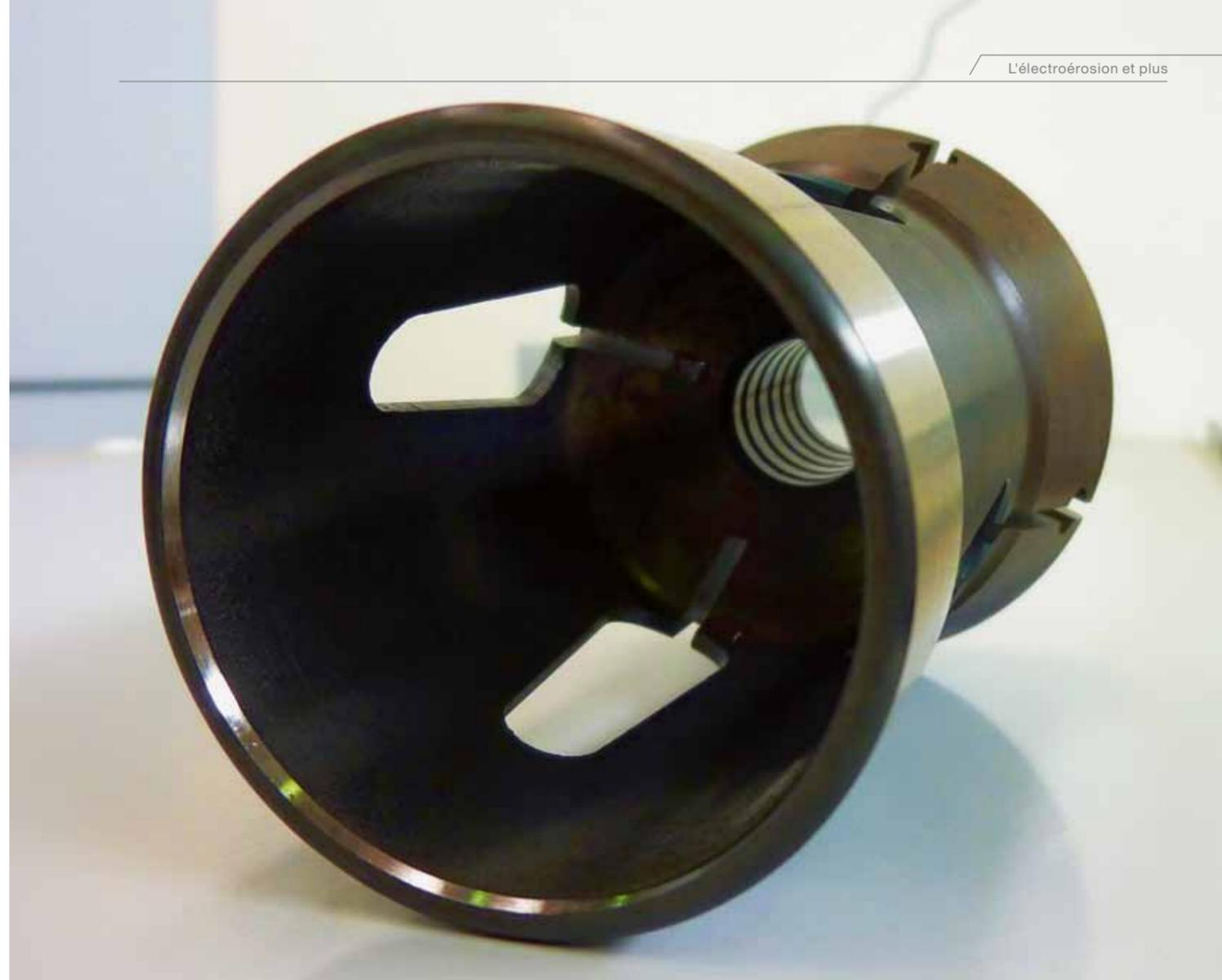
Pince semi-finie avec pré-forage et sur-épaisseur de finition par l'électroérosion à fil.
