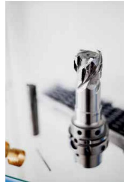
Lütticke fabrique des outils rotatifs avec plus de deux coupes sur le nouveau système doté d'un échangeur d'outils automatique.
