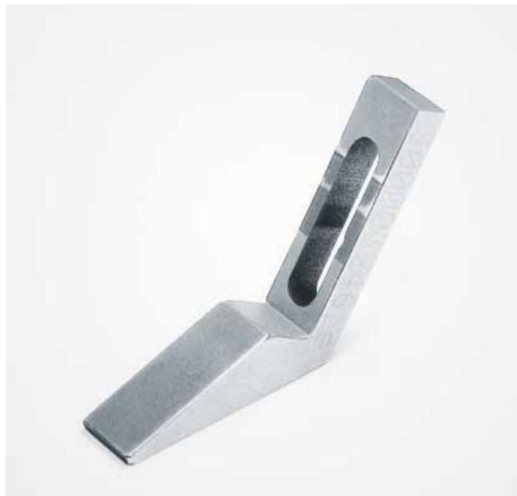
Dent de retenue en VA 1.4301, matériau à partir duquel le client a commandé plusieurs pièces. Möderer a fabriqué tout d'abord un plateau, coupe ensuite des trous oblongs sur toute la pièce et procède pour finir à l'électroérosion du contour extérieur de toutes les pièces durant la nuit, sans personnel de service.
