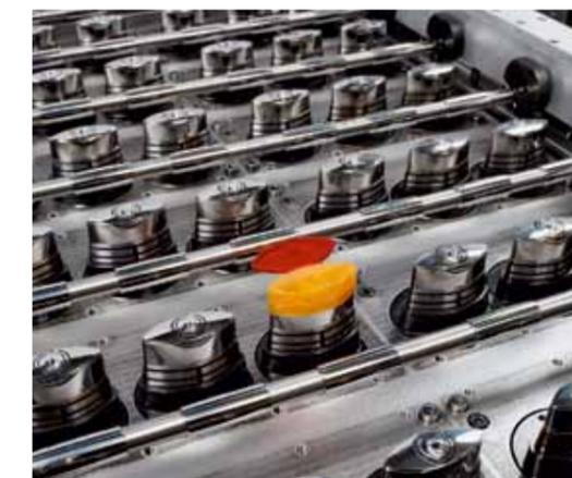
Con lo stampaggio a iniezione bimeriale si producono in un solo ciclo di lavoro pezzi stampati a iniezione di due colori o di due materiali diversi (le foto mostrano particolari dei semi-stampi per iniezione bimeriale con un prodotto finito all'interno)
