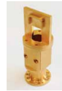
Gauche Porte-échantillon pour la mesure des propriétés physiques de matériaux sous vide et à basse température.
