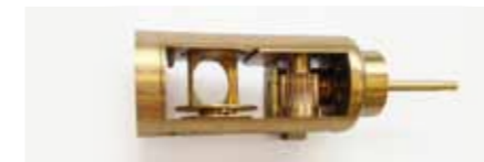
Au-dessous Porte-échantillon miniature rotatif pour les mesures jusqu'à 2° Kelvin (-271°C).
