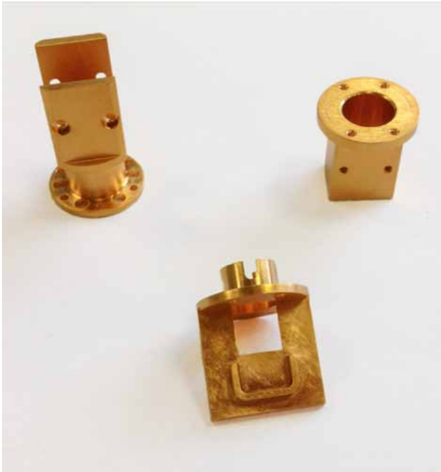
Parti di una sonda per basse temperature della Cryogenic Ltd.
