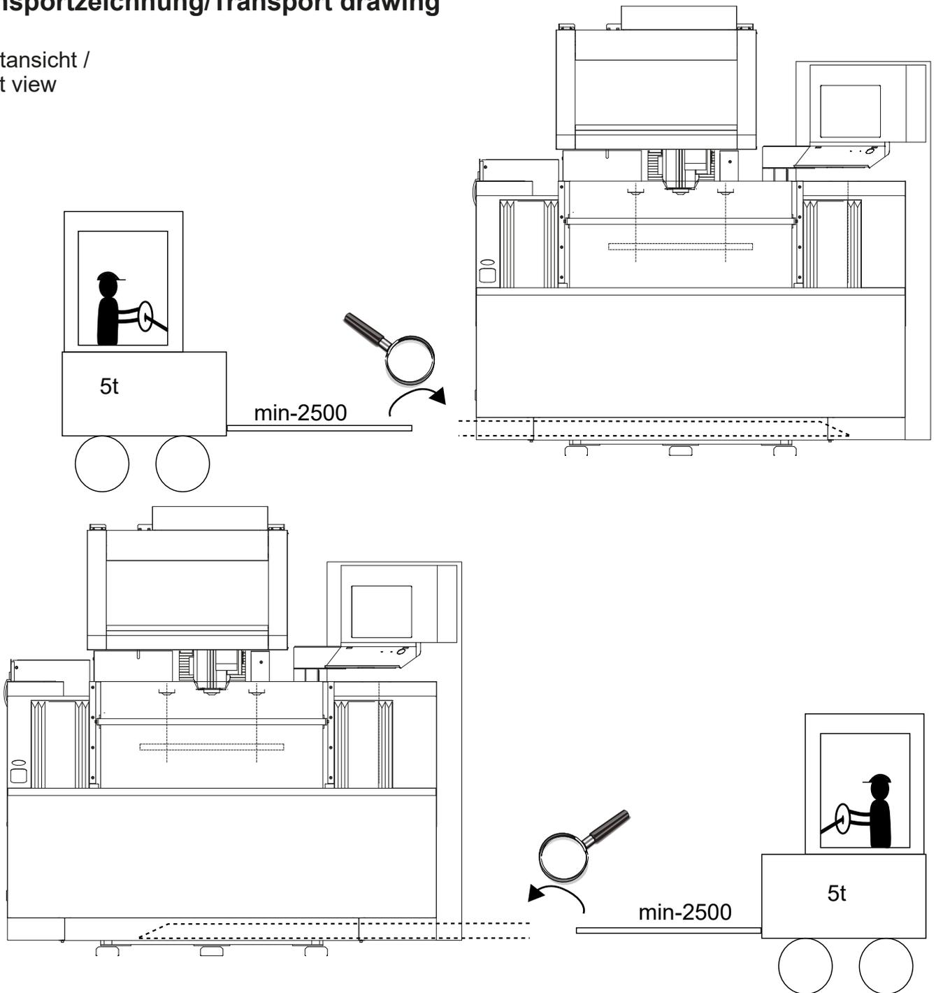
Der Transport der Maschine darf nur durch autorisierte Personen durchgeführt werden. Desweiteren sind die entsprechenden Unfallverhütungsvorschriften zu beachten. Das Hebegerät und die verwendeten Seile müssen in einem einwandfreien Zustand sein. Traversen zur Abladung der Maschinen mittels Kran müssen vom Kunden beigestellt werden
