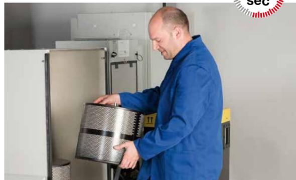
...sans outils ni perte de temps. Deux mains et 32 secondes – et le filtre est remplacé.
