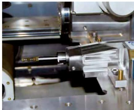
Broche rotative entièrement intégrée dans le contrôle de la machine pour les plus petits composants précis, par ex. : fabrication de tiges d'éjection ayant un diamètre supérieur ou égal à 0,05 mm, réalisation de filetages coniques pour la technologie médicale, ponçage et rotation érosifs, usinage simultané.
