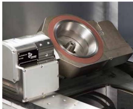
Pour usiner les angles coniques très exigeants en matière de précision : l'axe de rotation/pivotement intégré dans le contrôle de la machine. Usinage sur plusieurs axes jusqu'au centre de la pièce et usinage multilatéral lors d'un serrage, réalisation de polygones coniques très précis.
