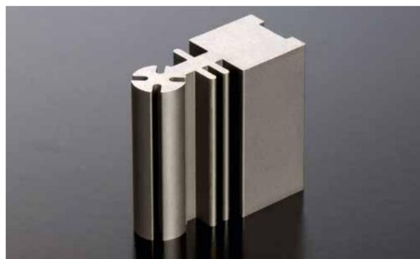
4 coupes de Ra 0,28  $\mu\text{m}$  par rapport à une machine conventionnelle.
