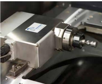
Un axe B servocommandé et entièrement intégré dans le contrôle de la machine vous permet d'effectuer une érosion à fil sur une pièce rotative. Vous pouvez ainsi effectuer des usinages positionnés ou continus avec l'axe B intégré.
