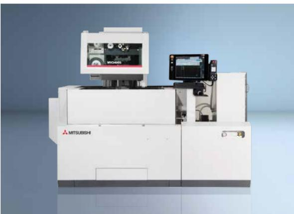
L'installation, la programmation et l'entretien sont autant d'éléments clés directement accessibles sur l'avant de la machine. L'alimentation en fil, le système d'enfilage automatique et les têtes guide-fils ainsi que l'espace de travail sont aisément accessibles, grâce au design ouvert de la machine et à l'ouverture verticale de la porte coulissante automatique.
