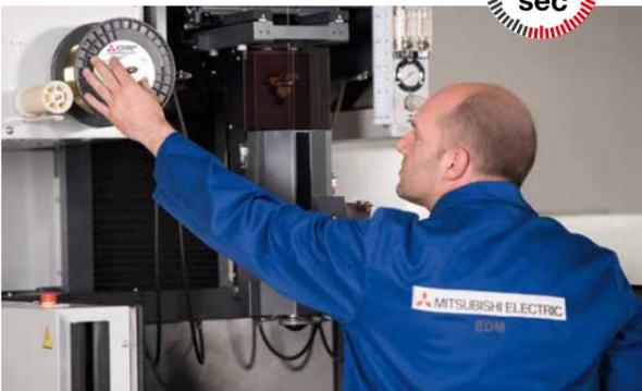
Remplacer simplement le rouleau et insérer le fil d'érosion au-dessus des rouleaux de transport. De nouveau prêt à fonctionner en 92 secondes.
