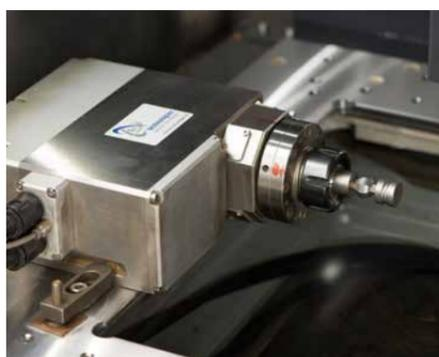
Полностью интегрированная в систему управления ось В с сервоуправлением обеспечивает обработку электродом-проволокой на вращающейся, синхронно подаваемой заготовке. Это позволяет выполнять деление и многостороннюю обработку в одном зажиме, а также проводить одновременную обработку.
