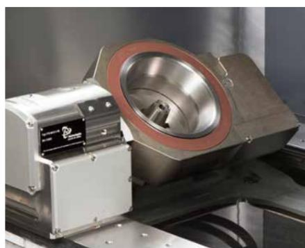
Для обработки конусов с максимальными требованиями к точности: интегрированная в систему управления станком ось вращения/качения. Многоосная обработка вплоть до центра заготовки и многосторонняя обработка в зажиме, реализация высокоточных конических многоугольников.
