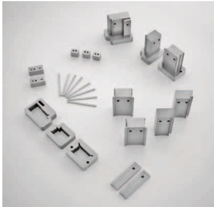
ne di stampi, elettrodi in grafite, utensili, profili nonché per produzioni singole o in serie. “Grazie al modello FA10-S Advance – sottolinea Papini – siamo in grado di realizzare lavorazioni di estrema precisione su punzoni”.
