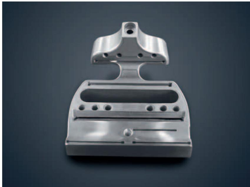
Guida-taglio, proveniente dal campo della tecnologia medica, che richiede incisioni praticate con determinati angoli, eseguite da SPEMA tramite erosione a filo con l'aiuto di un asse B.
