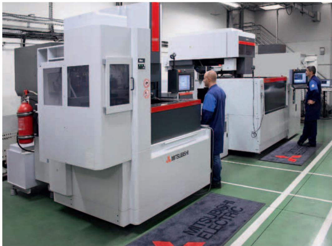
Per la produzione di molti pezzi, Sogameca utilizza prima l'erosione a tuffo per ottenere la forma desiderata e poi l'erosione a filo per praticare i tagli necessari.
