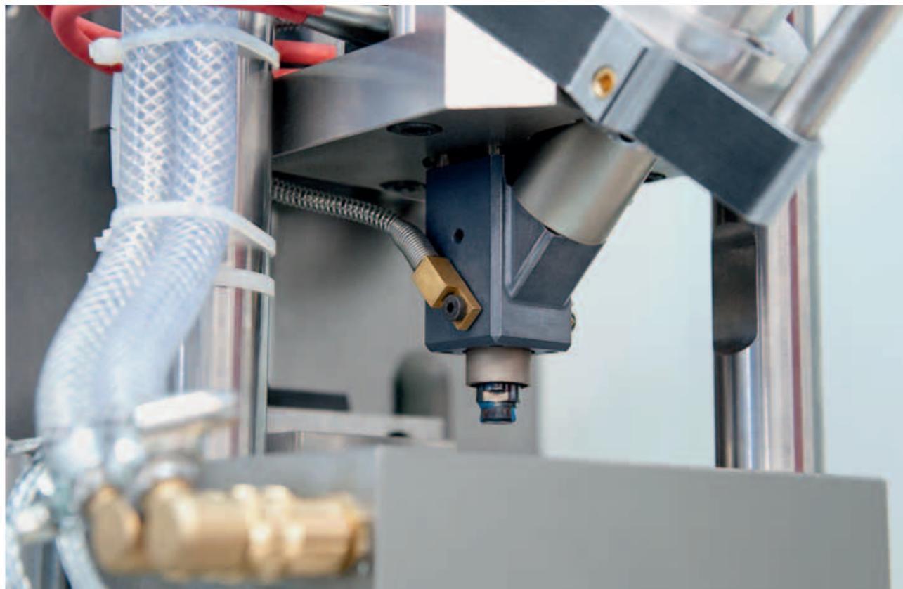
→ chili. L'ingombro sugli assi X,Y eZ è sufficientemente ampio con 400 x 300 x 300 mm. Il peso massimo per l'elettrodo è di 50 kg.
