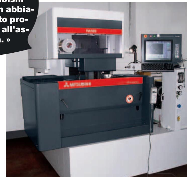
In basso a destra: Il modello FA10-S Advance è particolarmente indicato per la costruzione di stampi, elettrodi in grafite, utensili, profili nonché per produzioni singole o in serie.
