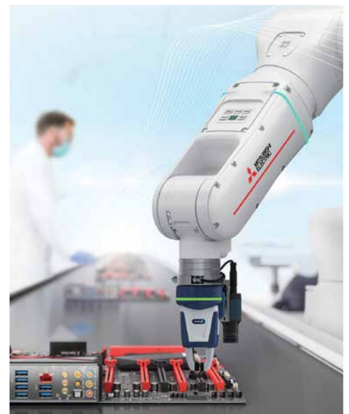
Der Melfa Assista eignet sich für das Handling kleinerer Lasten bis 5 kg.
