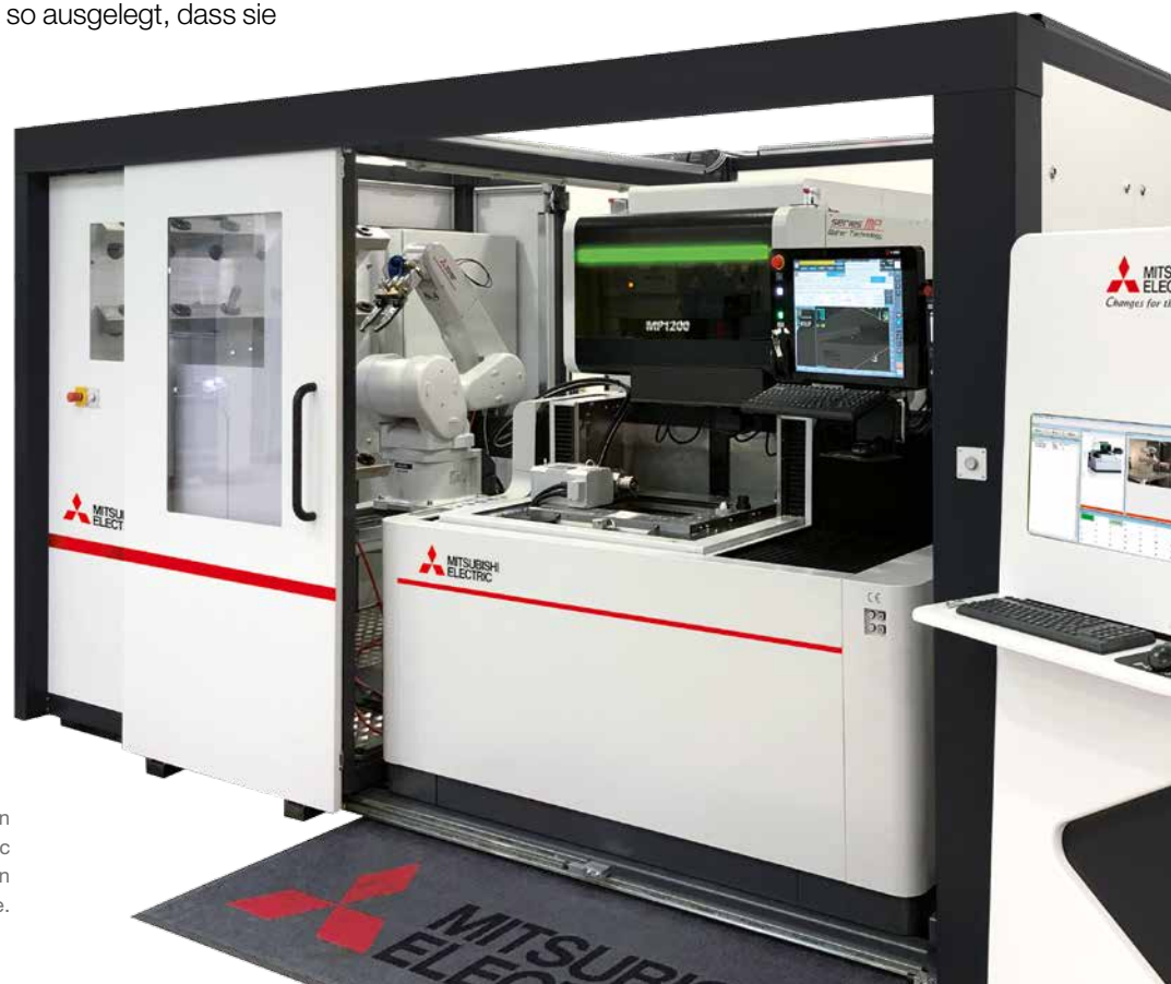
In der DiamondCell übernimmt ein Industrieroboter von Mitsubishi Electric die Zu- und Abfuhr von Schleifscheiben zur Drahterodiermaschine.
