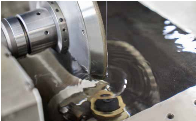
Schleifscheibe im Abrichtprozess
