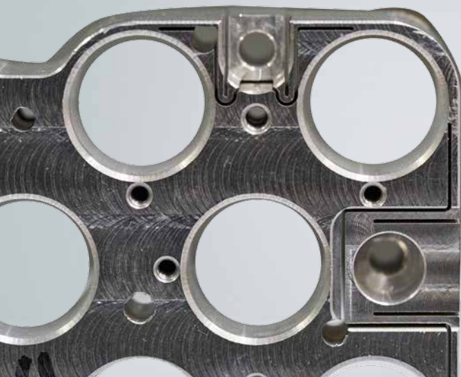
Erodierkontur zur flexiblen Ausrichtung der Plattenebene
