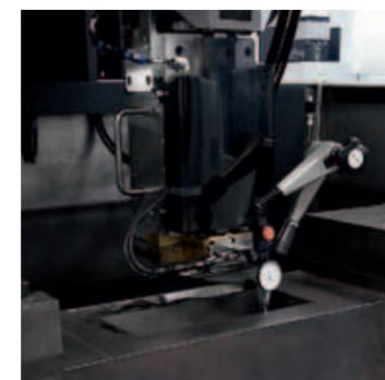
Die FA30-S Advance wurde mit erhöhter Z-Achse und Arbeitsbeckenvergrößerung ausgestattet, damit die großen Dornschlitten auf der Maschine Platz finden.
