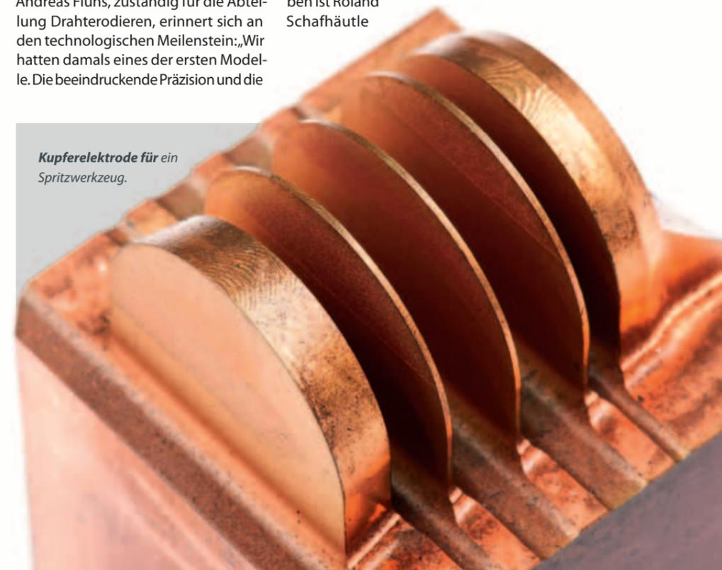
Der feine Draht der FA20-S Advance erzielt auch in kleinen Bohrungen optimale Oberflächen.
