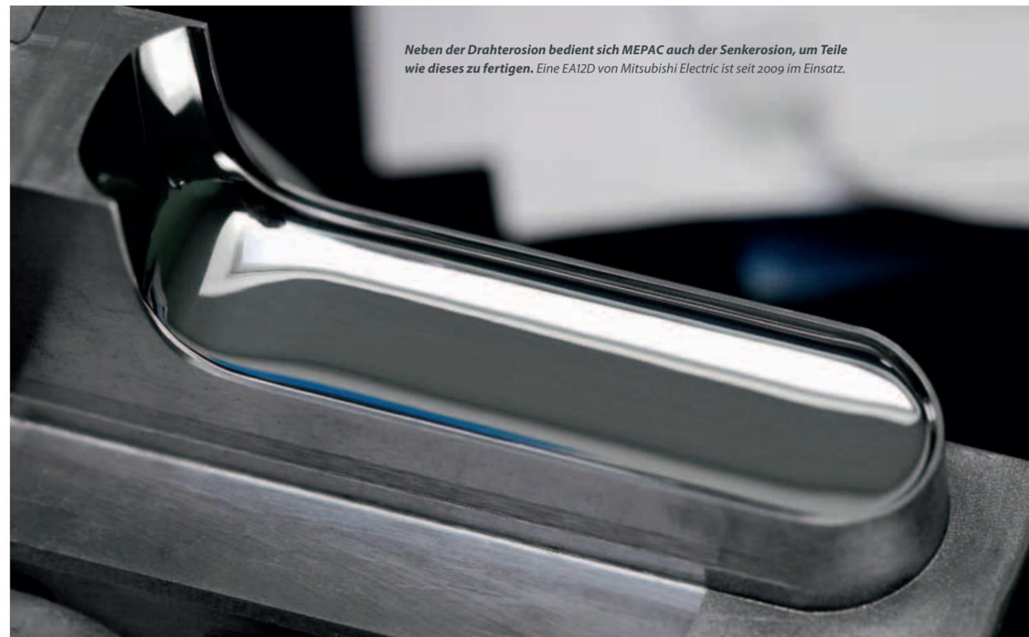
Neben der Drahterosion bedient sich MEPAC auch der Senkerosion, um Teile wie dieses zu fertigen. Eine EA12D von Mitsubishi Electric ist seit 2009 im Einsatz.
