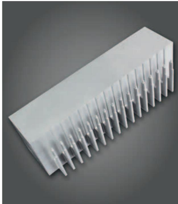
**Oben** Die kleinen Formkerne in der Mehrfachaufspannung sind schrittweise durch Drahterodieren, Senkerodieren und erneutes Drahterodieren entstanden.
