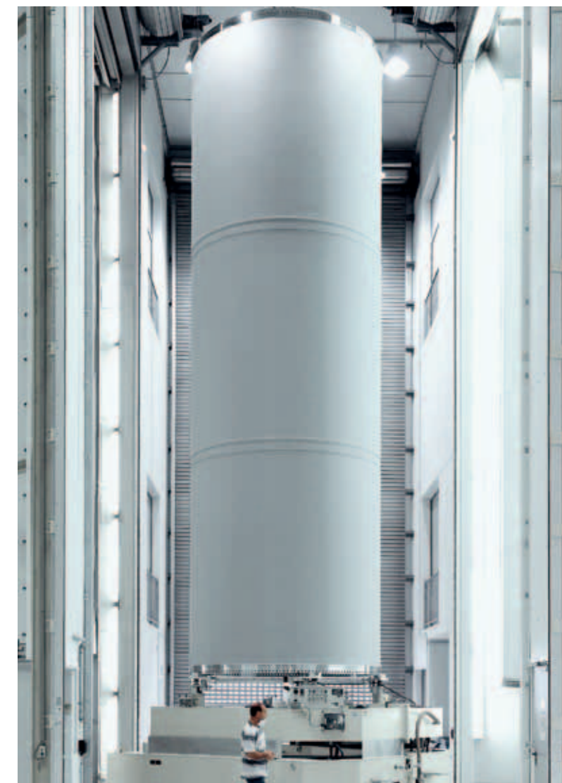
Zerspannung im großen Maßstab: Die Booster der Ariane 5 haben einen Durchmesser von 3 m und eine Gesamthöhe von ca. 25 m.
