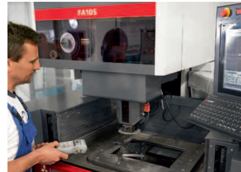
Exakte Positionierung des Drahts per Fernbedienung.
