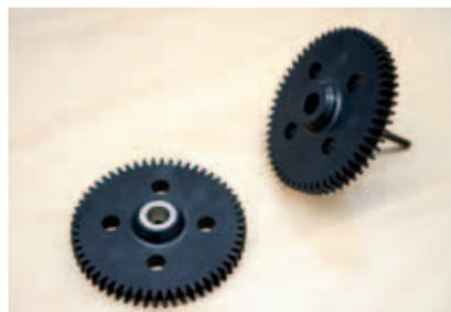
Oben Die FA10-S Advance schneidet Werkzeugkomponenten unterschiedlichster Art. Hier ist es eine Zahnradform. Im Bild das fertig gespritzte Kunststoffzahnrad.
