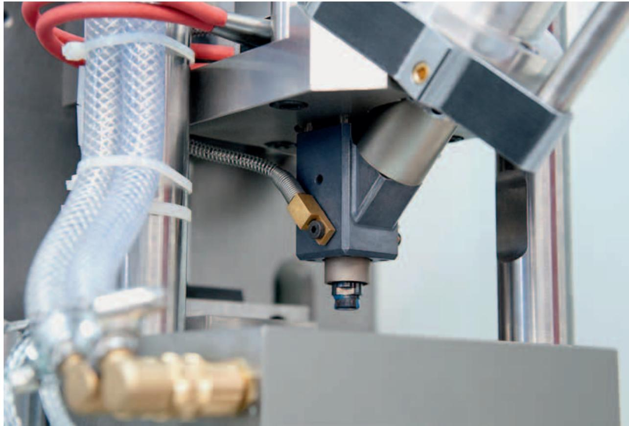
→ großen 400 x 300 x 300 Millimeter in X-, Y- und Z-Richtung. Das maximale Elektrodengewicht beträgt 50 Kilogramm.
