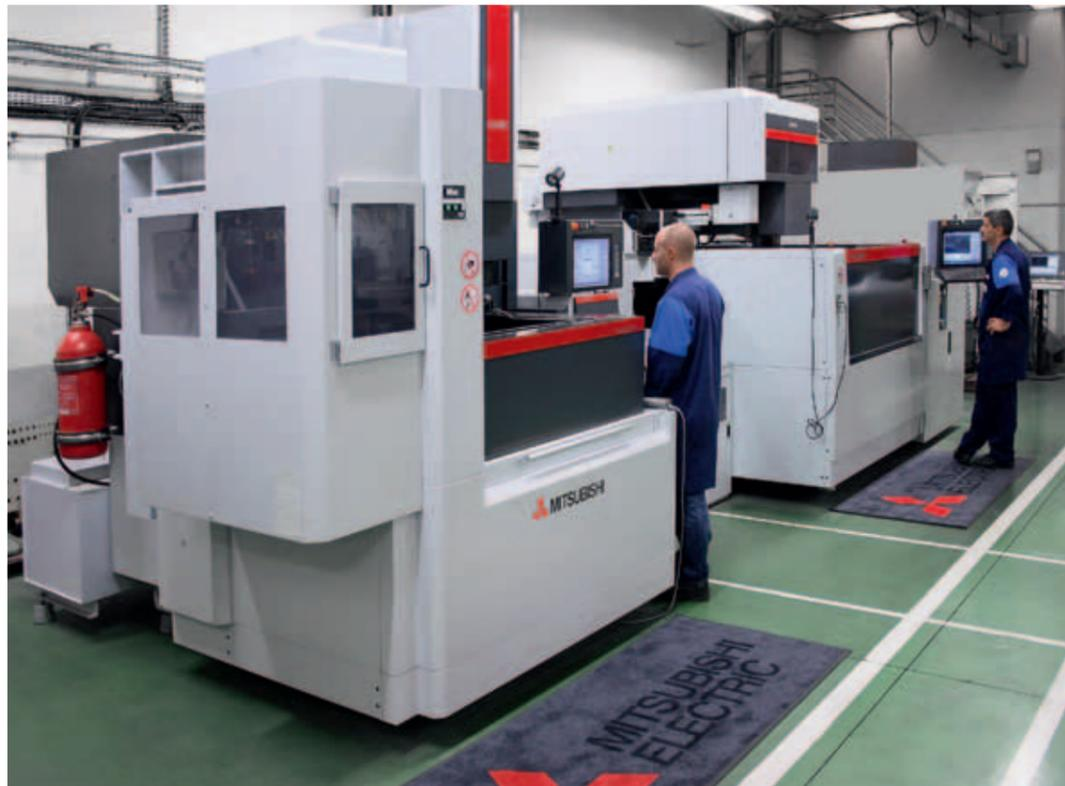
Viele Teile fertigt Sogameca, indem das Unternehmen durch Senkerodieren als erstes die gewünschte Form im Werkstück erzeugt und das Material dann mit einer Drahterodiermaschine schneidet.
