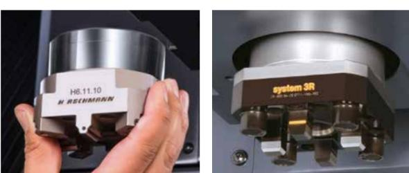
Ob Spannfutter von EROVA, System 3R oder Hirschmann – alles geht. Die Standard-Schnittstelle der C-Achse ist komplett flexibel.
