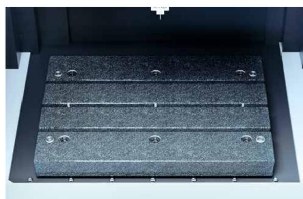
Der Arbeitstisch der SG8R ist in Granit ausgeführt. Durch geringe elektrische Kapazitäten erlaubt dies die exakte Rückmeldung und Optimierung der Generatorimpulse speziell bei kleinen Strömen in der Mikro-Bearbeitung. Grundsätzlich gilt Granit mit seinen speziellen Eigenschaften als der optimale Baustoff für den Präzisionsmaschinenbau: Hohe Steifigkeit, keinerlei Eigenspannungen und ein hohes Maß an Dämpfungskapazität unterstützen die Präzisionsbearbeitung im Senkerodieren.
