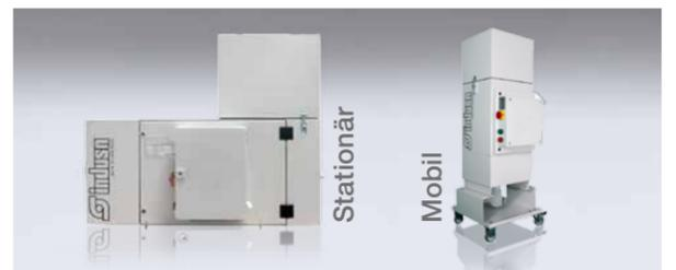
Abluftfilterung mit Rückführung in den Raum. Der elektrostatische Filter mit nachgelagertem Aktivkohlefilter befreit die angesaugte Abluft von Ölnebeln und Dämpfen. Stationär verbaut oder als mobile Anlage für den flexiblen Einsatz – abgestimmt auf die individuellen Bedürfnisse.
