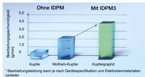
Deutliche Verbesserung der Abtragsleistung gegenüber herkömmlichen Maschinen: Bis zu 40 % mehr Bearbeitungsgeschwindigkeit ist bei Hartmetall realisierbar – durch den neuen IDPM. Der Einsatz von kupferinfiltriertem Graphit erhöht die Abtragsleistung deutlich – das Finish mit Wolframkupfer-Elektroden gleicht den etwas höheren Verschleiß aus – Performance und Präzision vereint. Auch in Hartmetall.
