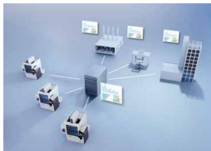
MTConnect ist der offene und lizenzfreie Kommunikationsstandard der Werkzeugmaschinenbranche. Dieser Standard wird von vielen führenden Softwareanwendungen für ERP, Fertigungs-Management und Produktionsmonitoring unterstützt. Die maschinen-seitige Schnittstelle ist bei der SG-R im Standard-Lieferumfang enthalten.
