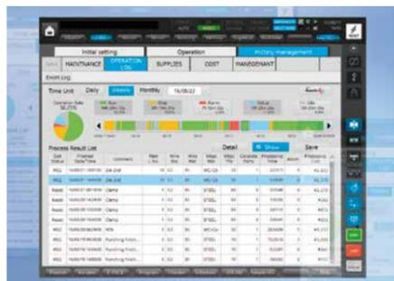
Betriebs- und Prozessdaten können auf der Steuerung abgerufen werden. Eine Exportfunktion aller Prozessdaten, Betriebszustände, Verbrauchsdaten und Wartungszustände wie auch der Alarmmeldungen ist im Standard verfügbar. So lassen sich Daten mehrerer Maschinen konsolidiert betrachten und auswerten, bis hin zur Integration in übergeordnete Produktionsmanagement-Systeme.
