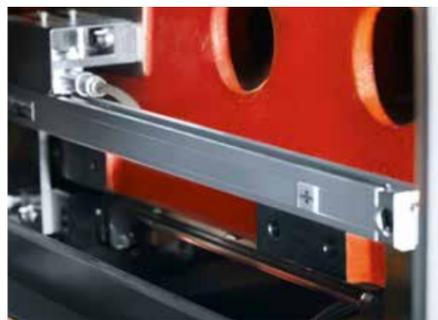
Bei der SG-R-Serie ist die höchste Präzision von Haus aus eingebettet – mit Glasmaßstäben auf X-, Y- und Z-Achsen sowie einer ausgefeilten Temperaturkompensation werden die Auswirkungen von Raumtemperaturschwankungen messbar minimiert.
