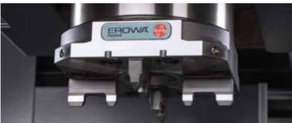
Rotieren mit bis zu 1500 U/min, als CNC-Achse simultan im Einsatz oder zur Positionierung der Elektrode – hiermit ist alles möglich. Hochdruckfest und immer CNC-integriert.
