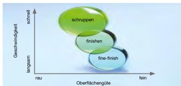
Die einzelnen Einheiten des Generators sind so aufeinander abgestimmt, dass besonders in Hartmetall sowohl eine gute Abtragleistung als auch bestes Oberflächenfinish erreicht werden können. Die Nano-Pulse-Feinschliffstufe erzeugt durch schnelle, feine Funken die feinst strukturierte Oberfläche. Kurz. Schnell. Nano.
