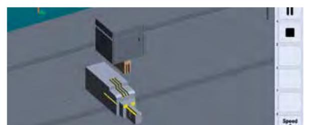
Erweiterung der Programmierfunktionalität auf der Maschinensteuerung um die Prüfung des erstellten Erodierprogramms anhand eingelesener 3D-Daten (Parasolid).
