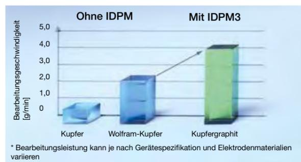
Deutliche Verbesserung der Abtragleistung gegenüber herkömmlichen Maschinen: Bis zu 40 % mehr Bearbeitungsgeschwindigkeit ist bei Hartmetall realisierbar – durch den neuen IDPM. Der Einsatz von kupferinfiltriertem Graphit erhöht die Abtragleistung deutlich – das Finish mit Wolframkupfer-Elektroden gleicht den etwas höheren Verschleiß aus – Performance und Präzision vereint. Auch in Hartmetall.
