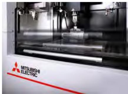
Gute Erreichbarkeit durch den dreiseitigen Hubtank ermöglicht bequemes und zügiges Einrichten. Der präzisionsgeschliffene Arbeitstisch in ergonomischer Höhe ist mit Standard-T-Nuten ausgestattet. Zur Beladung per Kran kann die Verkleidung im oberen Bereich einfach geöffnet werden.
