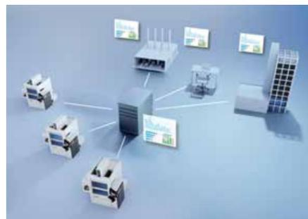
MTConnect ist der offene und lizenzfreie Kommunikationsstandard der Werkzeugmaschinenbranche. Dieser Standard wird von vielen führenden Softwareanwendungen für ERP, Fertigungs-Management und Produktionsmonitoring unterstützt. Die Maschinen der SG-S Serie können damit optional ausgestattet werden.
