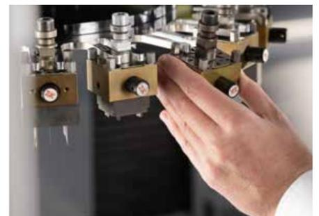
Der frontseitige Zugang zum Elektrodenwechsler erlaubt die ergonomische Beladung.
