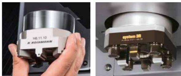
Ob Spannfutter von EROWA, System 3R oder Hirschmann – alles geht. Die Standard-Schnittstelle der C-Achse ist komplett flexibel.
