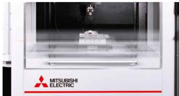
Gute Erreichbarkeit durch den dreiseitigen Hubtank ermöglicht bequemes und zügiges Einrichten. Der präzisionsgeschliffene Arbeitstisch in ergonomischer Höhe ist mit Standard-T-Nuten ausgestattet. Zur Beladung per Kran kann die Verkleidung im oberen Bereich einfach geöffnet werden.
