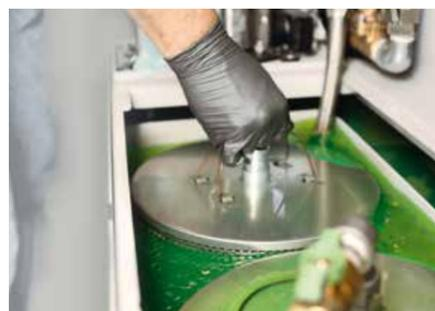
... im laufenden Betrieb – ohne Werkzeug oder Zeitverlust. Zwei Hände und 32 Sekunden – und der Filter ist ausgetauscht.
