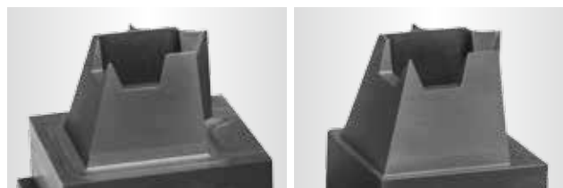
Herkömmlich erodiert: sichtbarer Kantenverschleiß
