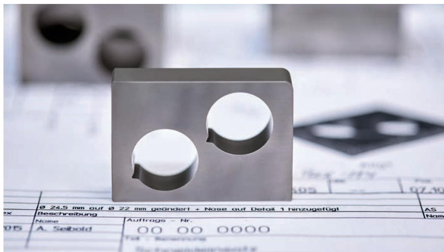
Schneidmatrize für ein Stanzwerkzeug
