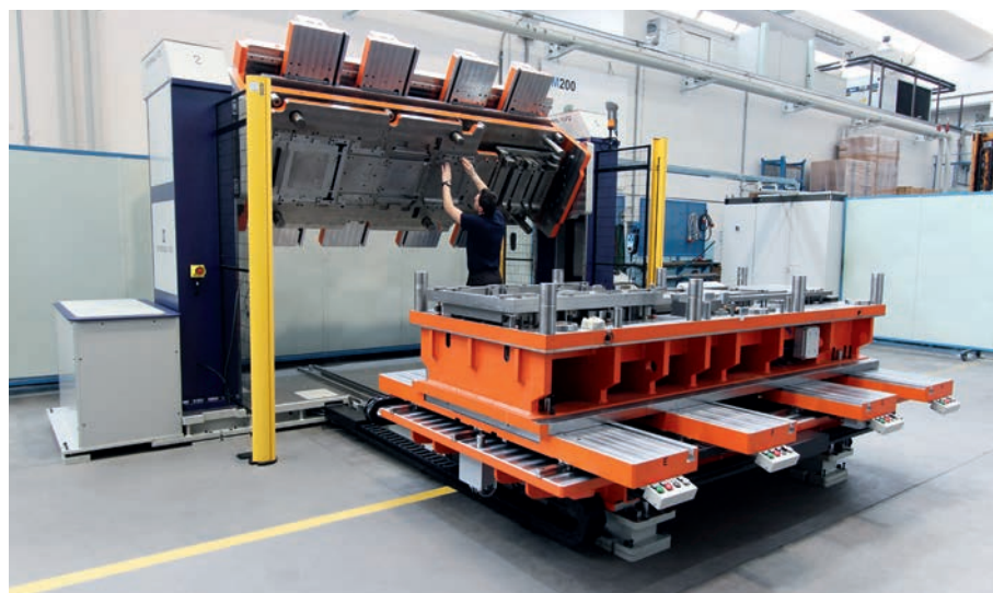
Die Maschine, die als „Werkzeug-Öffner“ bezeichnet wird, ist eine Erfindung von Universal1972 – ein echtes Flaggschiff. Sicheres Handling der Formen wird so gewährleistet.
