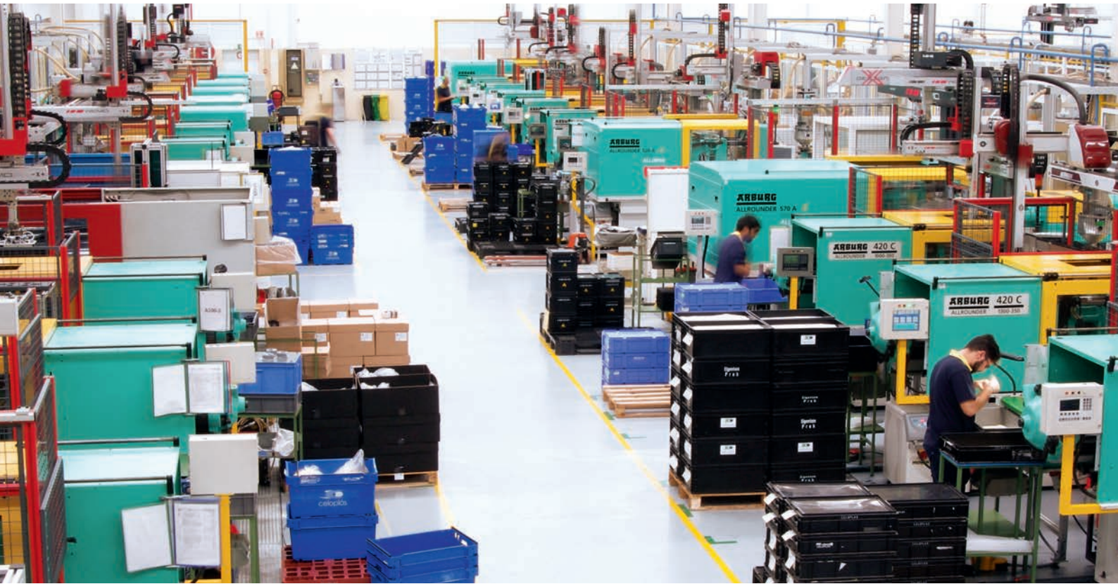
Zulieferer für den globalen Fahrzeugbau: automatisiertes Spritzgießen hochwertiger Interieur-Bauteile und Steckverbinder bei Celoplás in Portugal
