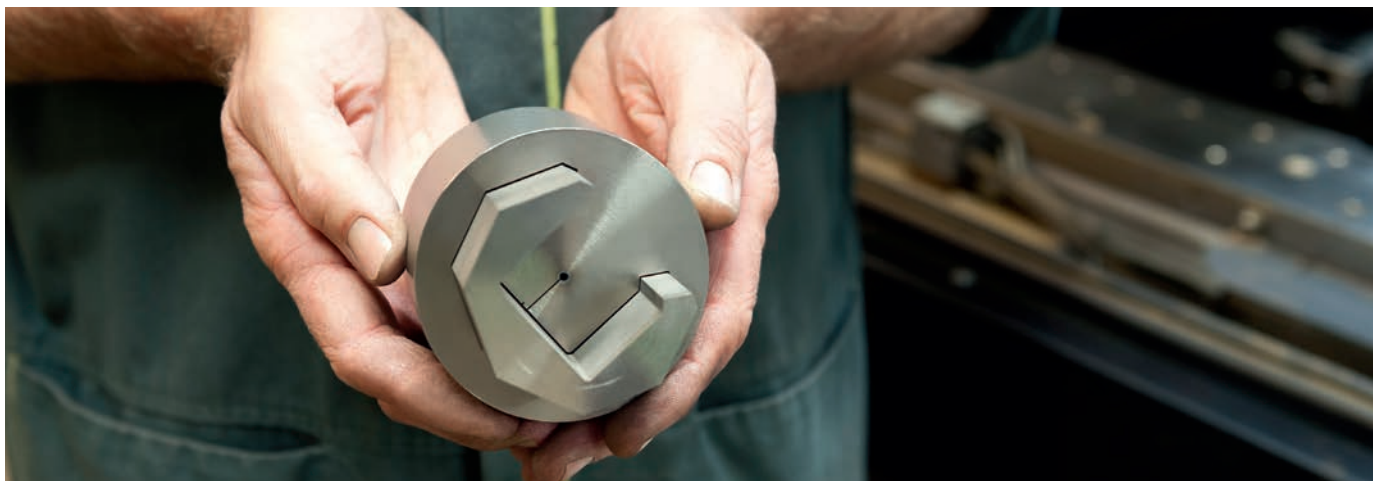
Hier passt alles zusammen: Drahterodieren auf der MV1200R von Mitsubishi Electric erübrigt häufig ein nachträgliches Schleifen.
