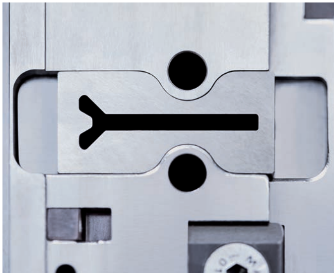
Hartmetall-Matrize im Stanzwerkzeug
