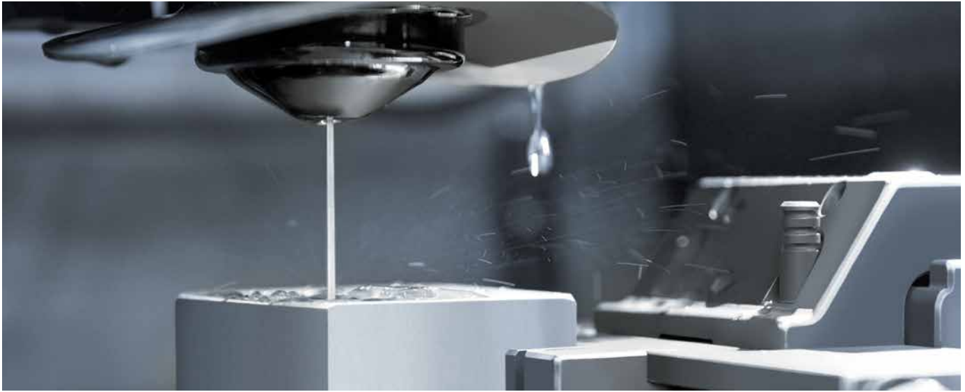
Beim Fertigen kleiner Präzisionsteile für Zähl- und Druckwerke hat sich die Drahterodiermaschine von Mitsubishi Electric bei Atlantic Zeiser bestens bewährt.
