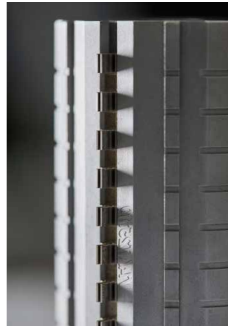
Bauteil (Walze) einer Lötvorrichtung für die Positionierung von Platinen
