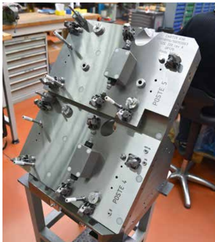
In Autechaux in Franche-Comté entwickelt, konzipiert und fertigt ITB Innovation innovative Spannsysteme für komplexe Bauteile wie z. B. Aluminiumgehäuse.
