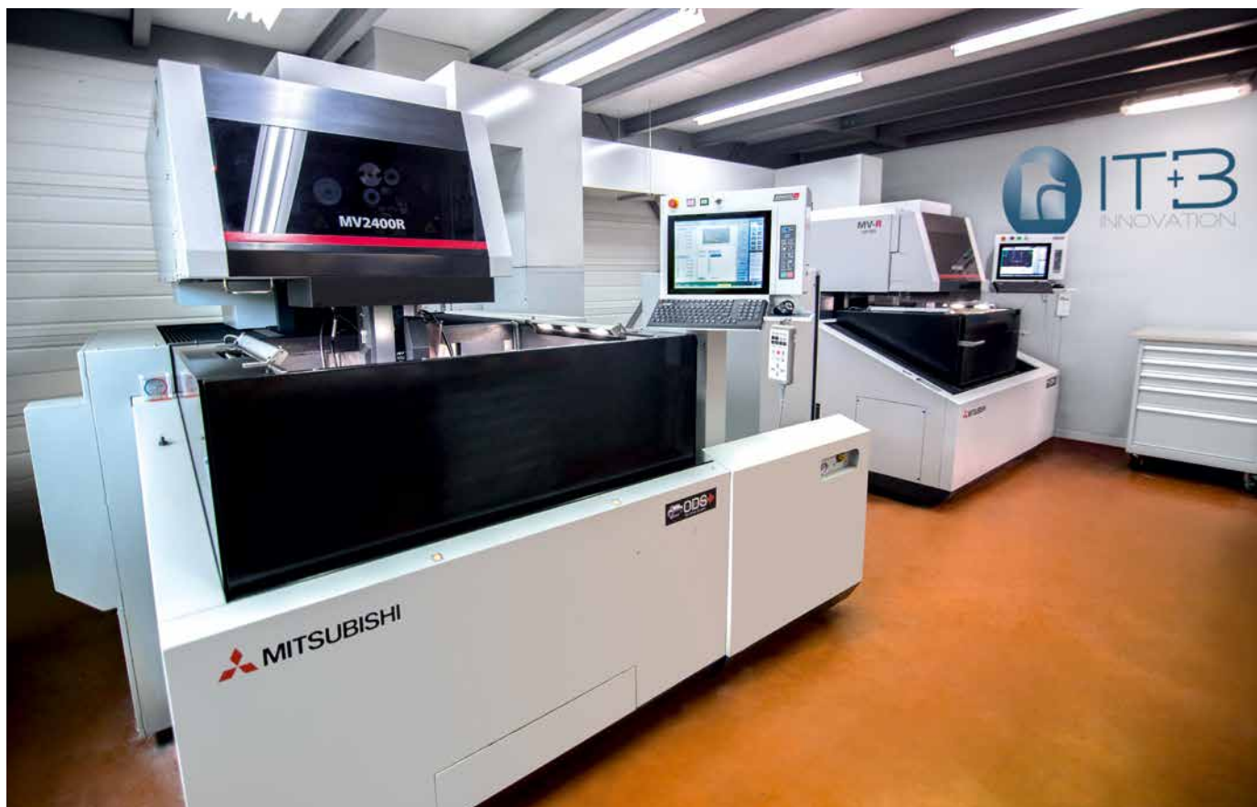
Garantiert hohe Präzision: ITB Innovation betreibt die Drahterodiermaschinen MV1200R und MV2400R in einem klimatisierten Raum mit kontrollierter Temperatur.
