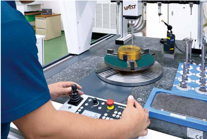
Die unter Einsatz von Erodiermaschinen erzeugten Matrizen werden abschließend mit dem Koordinatenmessgerät überprüft.
