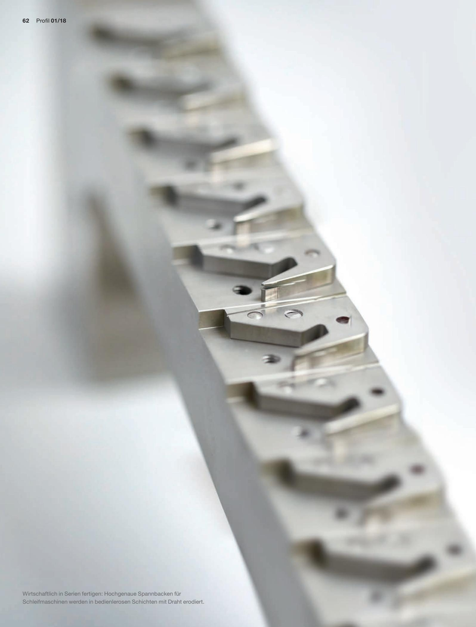
Wirtschaftlich in Serien fertigen: Hochgenaue Spannbacken für Schleifmaschinen werden in bedienlosen Schichten mit Draht erodiert.
