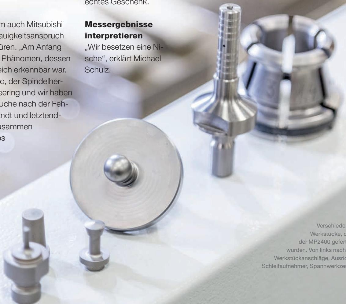
Verschiedene Werkstücke, die auf der MP2400 gefertigt wurden. Von links nach rechts: Werkstückanschlüsse, Ausrichtdorn, Schleifaufnehmer, Spannwerkzeug.
