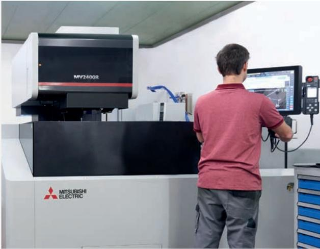
Überzeugend einfach: Programmieren und Bedienen der MV2400R an der CNC-Steuerung mit Touch-Screen
