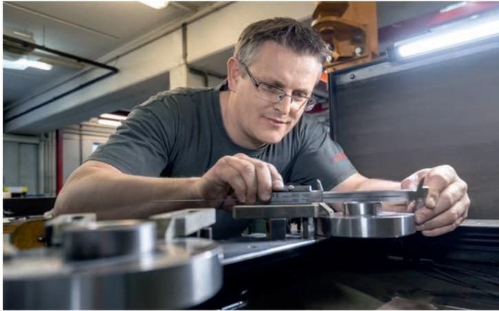
Präzision im Fokus: Die Qualität der drahterodierten Bauteile wird sehr sorgfältig überprüft.
