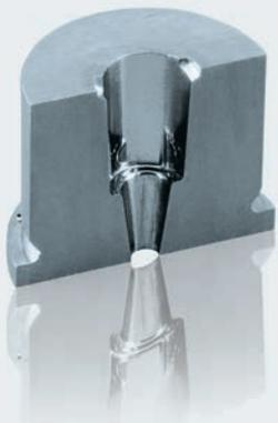
Senkerosiv hergestellte und polierte Düse – zu Prüfzwecken aufgeschnitten.
