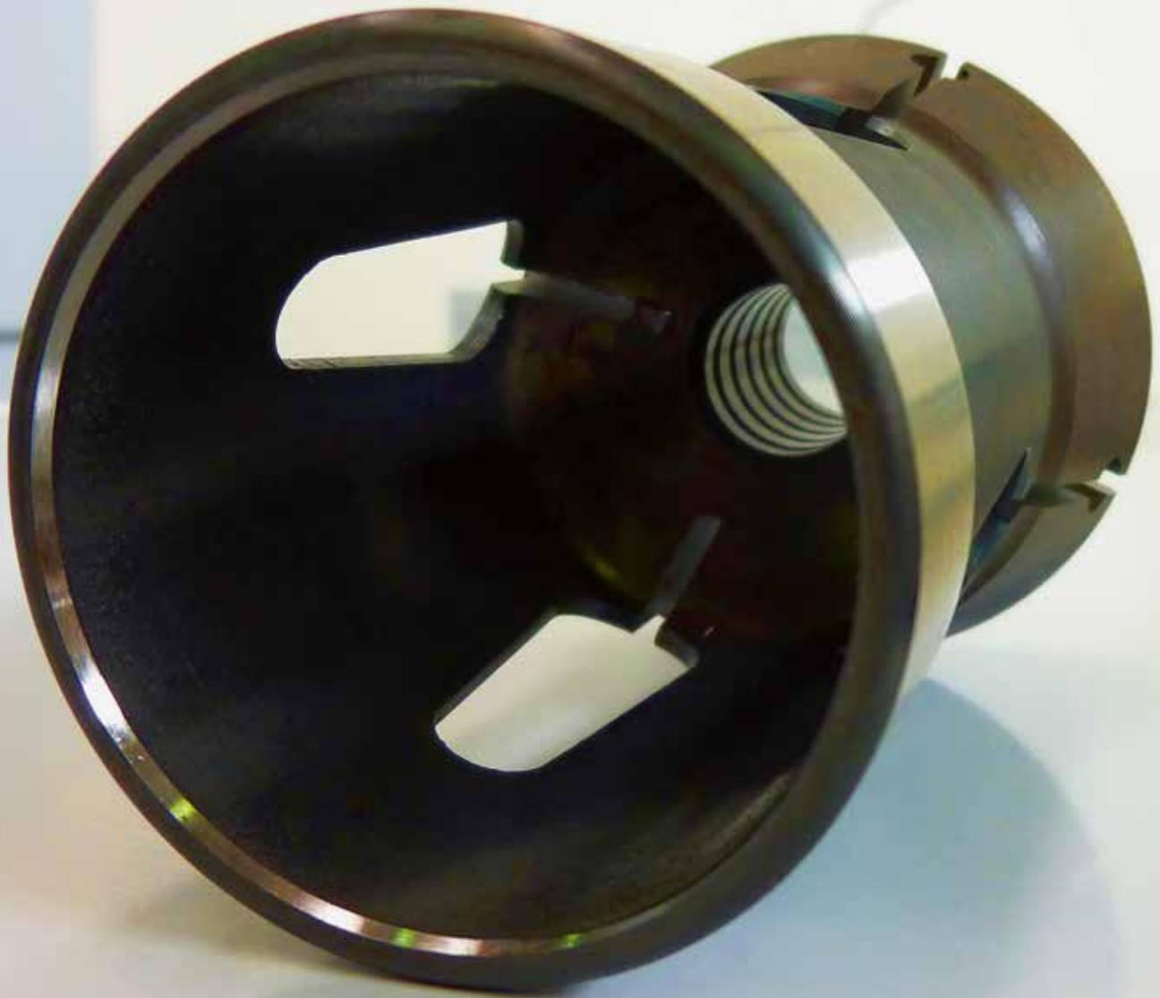
Halb fertige Zange mit Vorbohrung und Schlichtaufmaß aus EDM.
