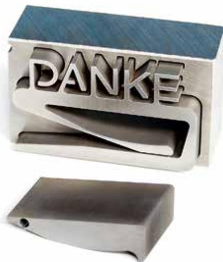
Molybdän gefertigt worden ist. „Da ein Fräs Werkzeug bei solch einem harten Metall brechen könnte und Prozesssicherheit für uns höchste Priorität hat, haben wir in dem Fall lieber erodiert.“ Hinsichtlich der Präzision reicht der Empa meist ein hundertstel Millimeter. Die erforderliche Oberflächengüte liegt bei einem Mittenrauwert von 0,8 bis 0,4 Mikrometer.
