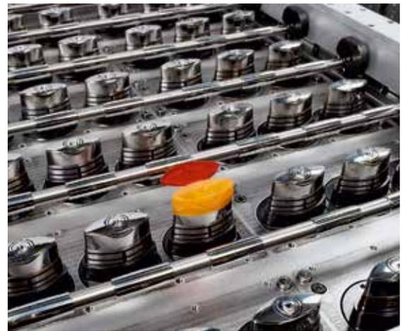
Der Zwei-Komponenten-Spritzguss erzeugt in einem Arbeitsgang zweifarbige oder aus zwei Materialien kombinierte Spritzgießteile (Ausschnitte aus den Formhälften für den Zwei-Komponenten-Spritzguss mit einem eingelegten Fertigprodukt).
