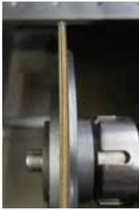
Links oben Metallisch gebundene Diamant-Schleifscheibe D46
