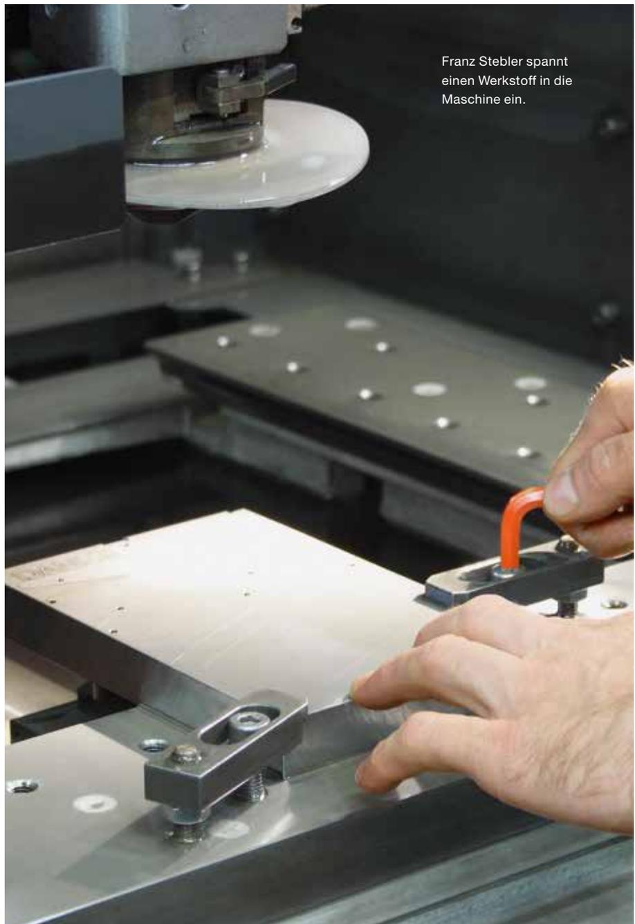
Franz Stebler spannt einen Werkstoff in die Maschine ein.
