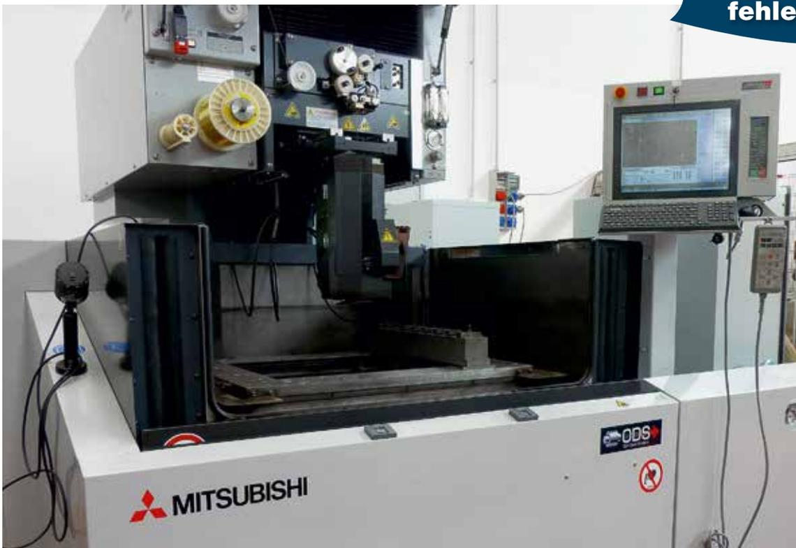
Das Drahtefädelverhalten des neuen Modells Mitsubishi MV2400R erfolgt nicht nur vollkommen automatisch, sondern gewährleistet auch ein hohes Maß an Zuverlässigkeit und gleichmäßige Ergebnisse.
