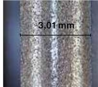
→ tungsvorgangs wird das elektrisch leitende Bindemittel abgetragen, sodass die freigelegten Schleifkörper (CBN- oder Diamantpartikel) frei auf der Schleifscheibenoberfläche liegen. Schleifkörper, die sich außerhalb der Endgeometrie befinden, fallen einfach mit dem abgetragenen Bindemittel aus der Scheibe.
