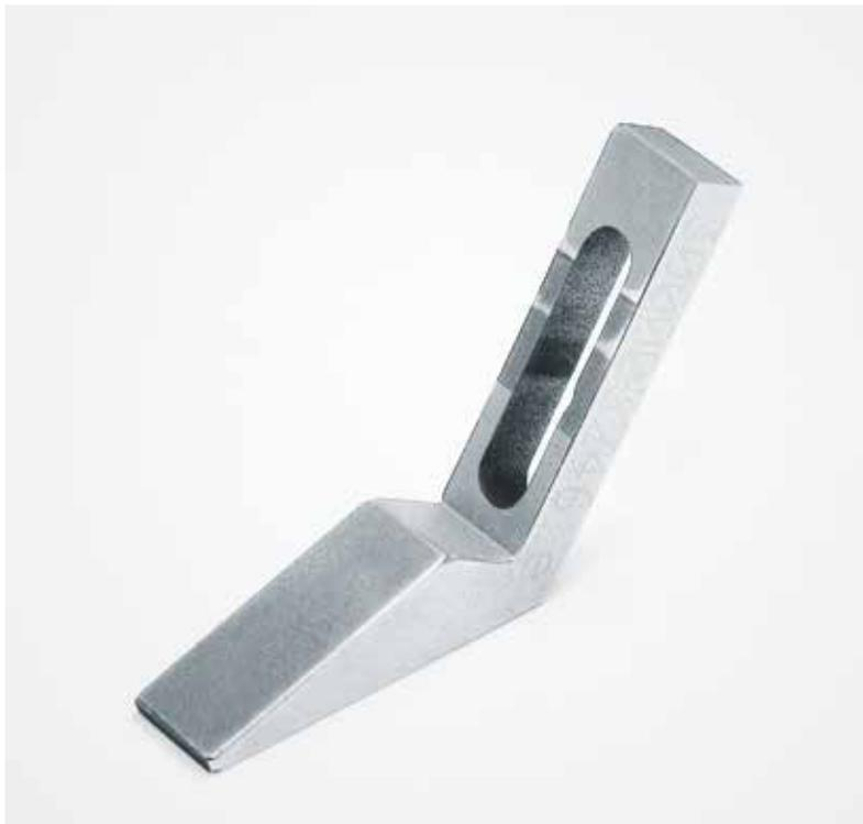
Rechenzahn aus VA 1.4301, von dem der Kunde mehrere Teile bestellte. Möderer fertigte zunächst eine Platte an, schnitt dann das Langloch durch sämtliche Teile und erodierte abschließend die Außenkontur aller Teile nachts mannlos.
