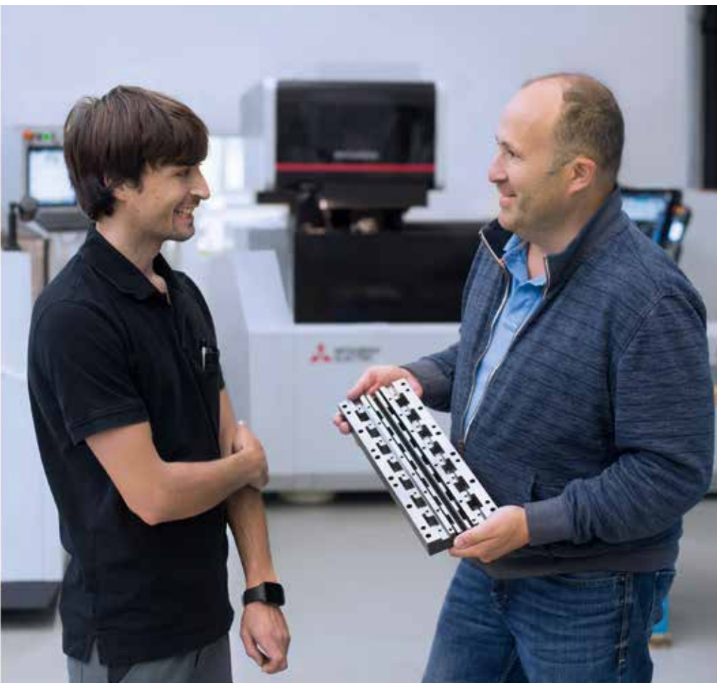
Die Drahterodiermaschine hat saubere Arbeit geliefert: Alle Taschen der Schnittplatte wurden in hoher Qualität ausgeschnitten.
