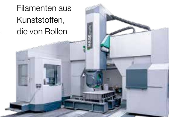
Portal-Bearbeitungszentrum mit X-Fahrweg bis 70 Meter
