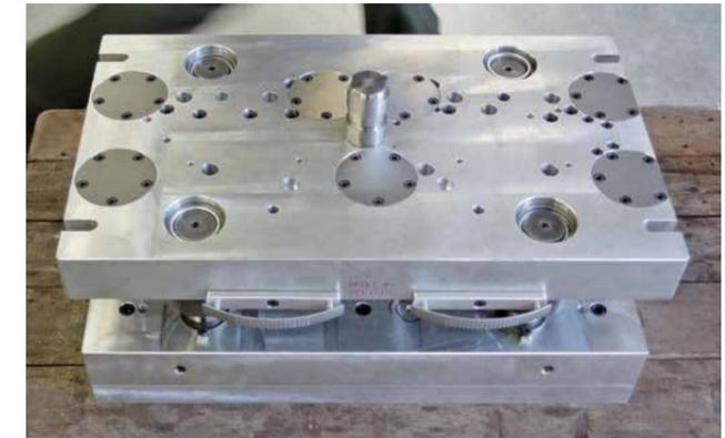
Das fertig montierte Stanzwerkzeug bereit für den Abtransport
