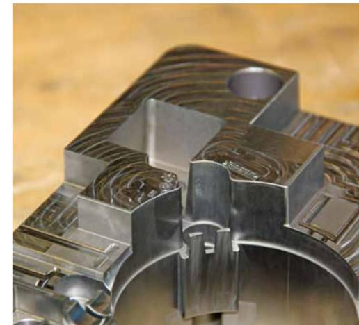
viel weniger Nachschritte nötig und die Oberflächenqualität der Werkstücke ist erheblich gestiegen.“ Im Vergleich zur alten Maschine ist bei gleicher Oberflächengüte ein Schnitt weniger nötig – so die Einschätzung von König. Einsparungen gibt es auch beim Draht- und Stromverbrauch. Hier reduzieren optimierte Drahtlaufgeschwindigkeiten für verschiedene Bearbeitungsbedingungen bei der neuen MV2400R den Drahtverbrauch um bis zu 45 Prozent. Generell werden auf der Ma-
