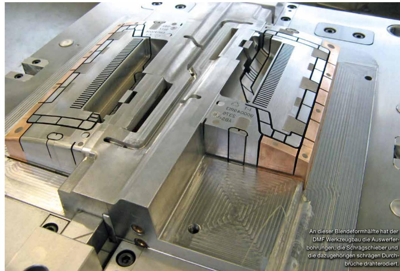
An dieser Blendeformhälfte hat der DMF Werkzeugbau die Auswerferbohrungen, die Schrägschieber und die dazugehörigen schrägen Durchbrüche drahterodiert.
