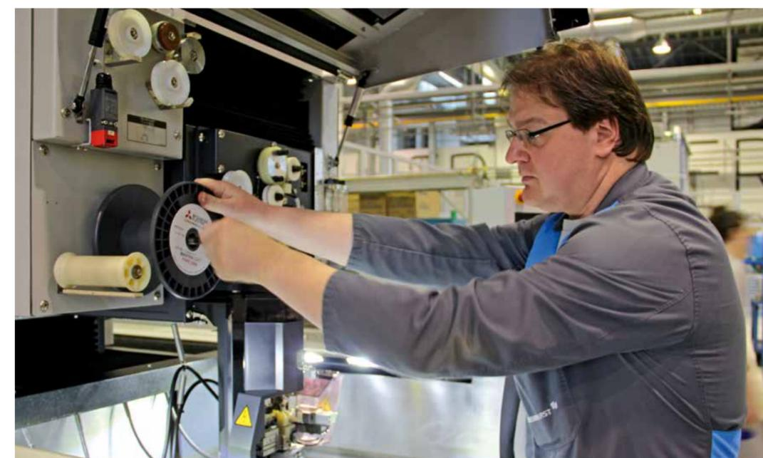
Harald König beim Einfädeln des neuen Drahtes – dank automatischer Drahtefädung stellt dies kein Problem mehr dar.
