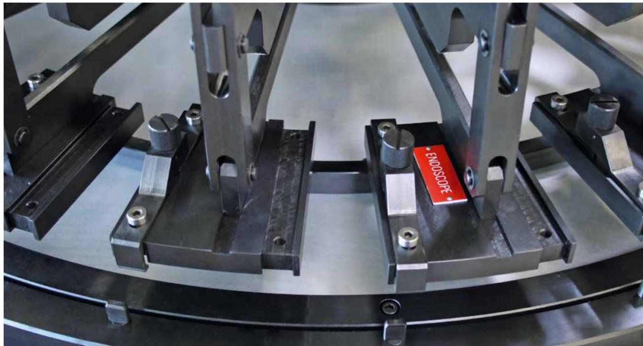
An diesem Montagekarussell für die Luftfahrtindustrie sind einzelne Komponenten drahterodiert worden.
