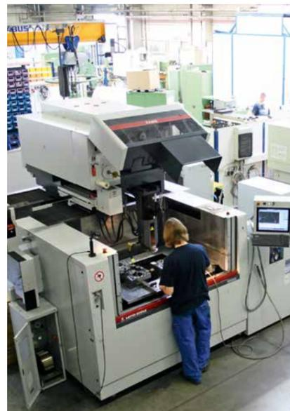
Der DMF Werkzeugbau blickt auf etwa 15 Jahre Erfahrung im Drahterodieren zurück und hat diese Technik komplett im Haus.
