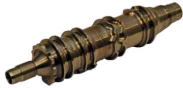
Schaltwalze eines Formel 1 Boliden. Bei jedem Nocken wird der Gang gewechselt.
