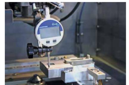
Philippe Chandivert, opérateur de la MV1200S Tubular, relève sur son terminal portable les données mesurées par le comparateur.
