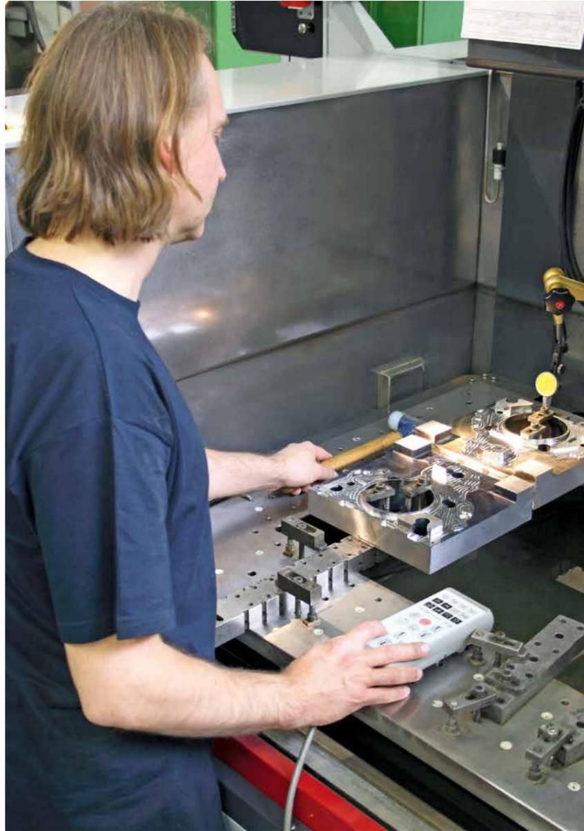
L'entreprise DMF Werkzeugbau usine les inserts et les noyaux de moule, les lames et les poinçons de coupe ainsi que les glissières sur les machines d'électroérosion à fil.
