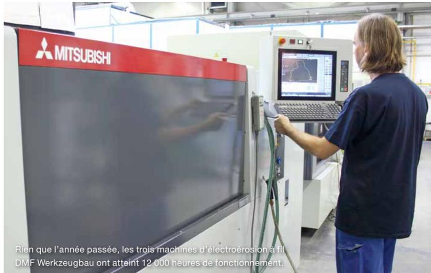
Rien que l'année passée, les trois machines d'électroérosion à fil DMF Werkzeugbau ont atteint 12 000 heures de fonctionnement.
