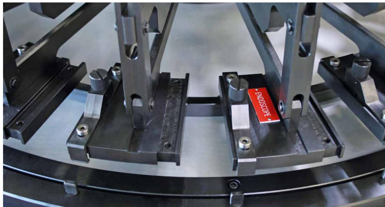
Sur ce carrousel de montage pour l'industrie aéronautique, certains des éléments ont été fabriqués par électroérosion à fil.
