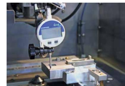
Philippe Chandivert, operatore sulla MV1200S Tubular, legge i dati rilevati con il comparatore sul suo terminale portatile.
