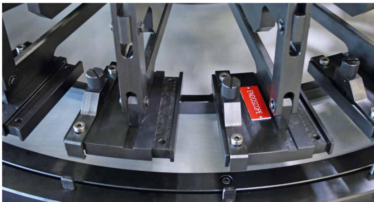
Questo carosello di montaggio per l'industria aeronautica conta diversi componenti lavorati per erosione a filo.
