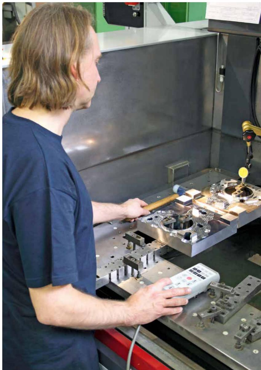
Sulle macchine per elettroerosione la DMF Werkzeugbau realizza inserti, nuclei, lame di taglio, punzoni e cursori.
