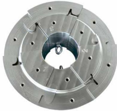
Kernunterseite nach der Fräsbearbeitung
