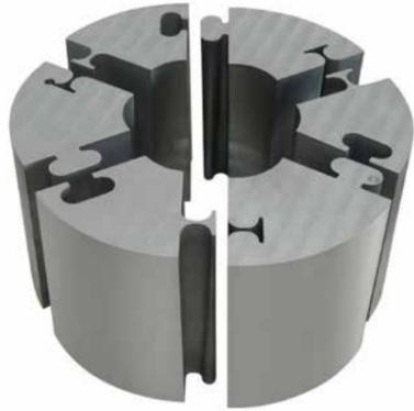
Der Rohling ist für einen RTM-Werkzeugkern für das Entwicklungsprojekt „Flugzeugfelge“ aus Carbon, hier im Bild nach dem 5-achsigen Drahterodieren. Der zunächst geschlossene Ring wurde in sechs Segmente geteilt.
