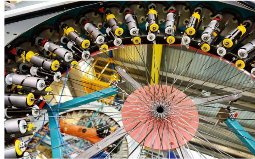
Ein Beispiel für die Herstellung von Leichtbau-Werkstoffen steht am Institut für Flugzeugbau (IFB) der Universität Stuttgart. An dem mannshohen Flechtrad sind rundherum Spulen mit Carbonfasern angebracht. Wenn es sich dreht, fügen sich 78 Fäden ineinander.
