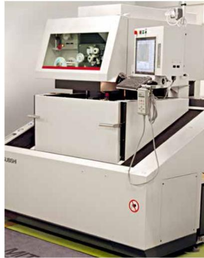
Hat beim Lohnfertiger in LaChapelle die Erwartungen erfüllt: Drahterodiermaschine MV1200S von Mitsubishi Electric
