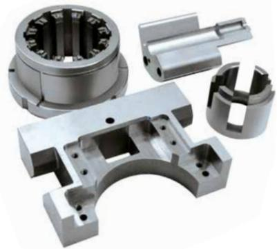
Durchbrüche mit Ecken, tiefe Nuten, Innenverzahnungen: Bei Einzelteilen aus gehärtetem Stahl erweist sich Drahterodieren als prozesssicher, genau und – wegen der Produktion in unbeaufsichtigten Nacht- und Wochenendschichten – als besonders wirtschaftlich.
