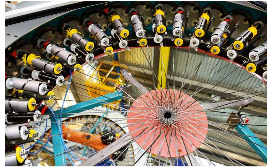
Un exemple de fabrication des matériaux de construction légère se trouve à l'Institut de Construction Aéronautique (IFB) de l'Université de Stuttgart. Des bobines dotées de fibres de carbone sont installées tout autour des roues tressées à hauteur d'homme. Si ça tourne, 78 fils s'intègrent.
