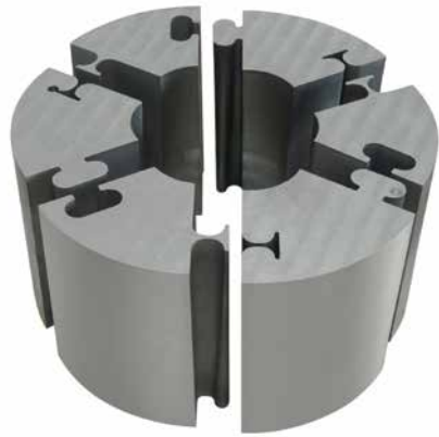
L'ébauche correspond au cœur d'un outil RTM pour le projet de développement « jantes d'avion » en carbone, ici sur l'image après une érosion à fil sur 5 axes. L'anneau initialement fermé a été divisé en six segments.
