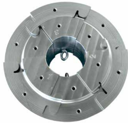
Parte inferiore del nucleo dopo la fresatura
