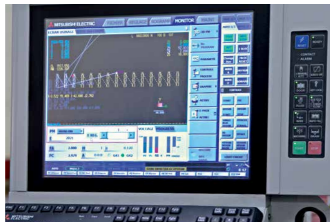
Facile da capire anche per i dipendenti meno pratici: il controllo intuitivo dei comandi CNC ADVANCE PLUS sulla macchina per elettroerosione a filo MV2400R
