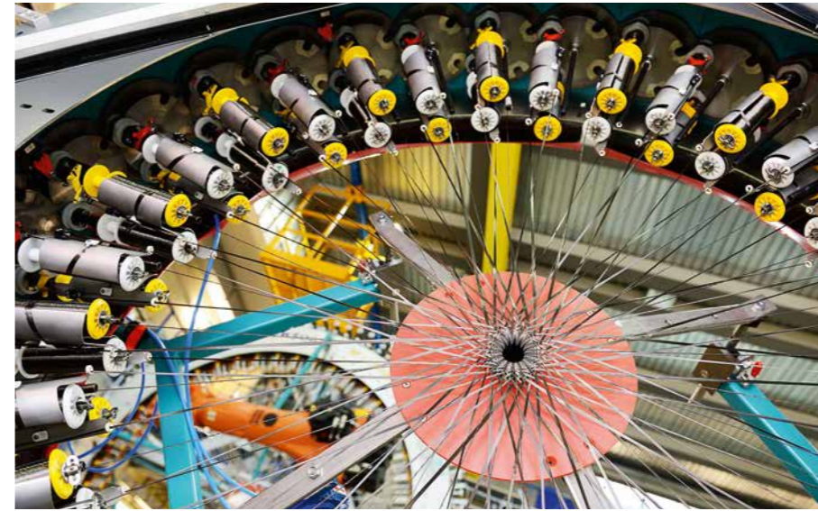
Un esempio di produzione di strutture leggere presso l'Istituto di progettazione di aeromobili (Institut für Flugzeugbau – IFB) dell'Università di Stoccarda. Lungo la circonferenza del telaio radiale, alto quanto un uomo, sono disposte bobine con fibre di carbonio. Quando il telaio gira si intrecciano 78 fili.
