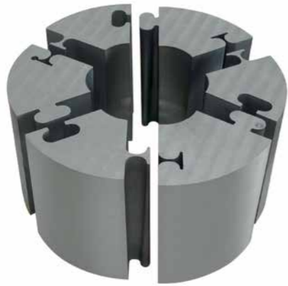
Il grezzo è per il nucleo di un utensile RTM destinato al progetto di sviluppo di un "cerchione di ruota per aerei" in carbonio, qui dopo la lavorazione a erosione a filo su 5 assi. L'anello, dapprima intero, è stato suddiviso in sei segmenti.
