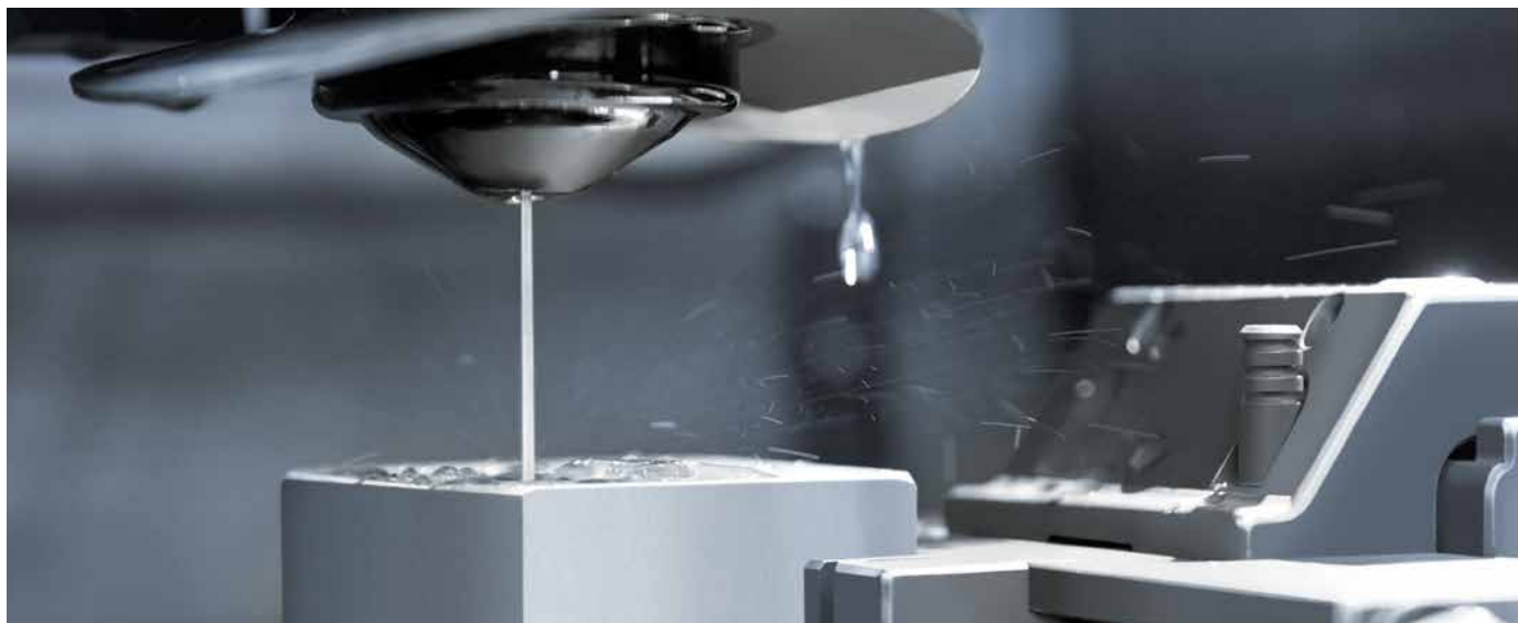
La machine d'électroérosion à fil de Mitsubishi Electric installée à Emmingen a fait ses preuves pour l'usinage de petites pièces de précision destinées aux machines de numérotation et d'impression.
