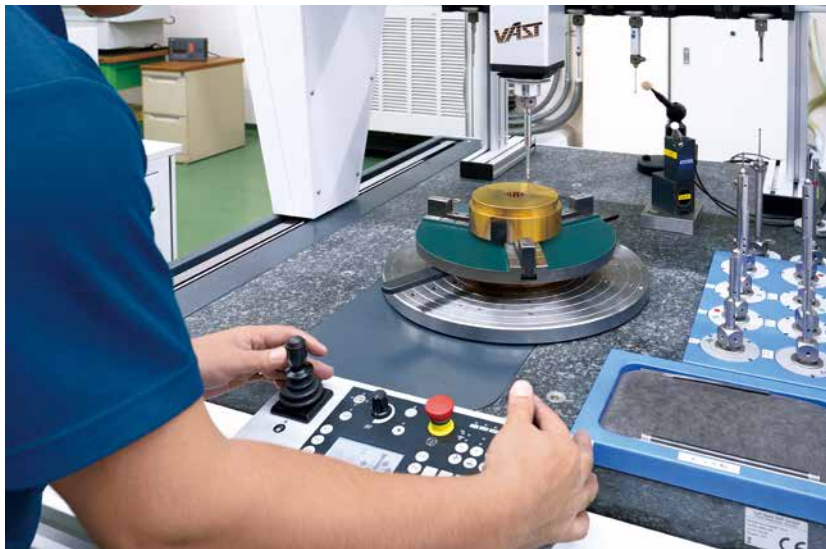
Les matrices produites sur les systèmes d'électroérosion sont ensuite contrôlées avec l'appareil de mesure de coordonnées.
