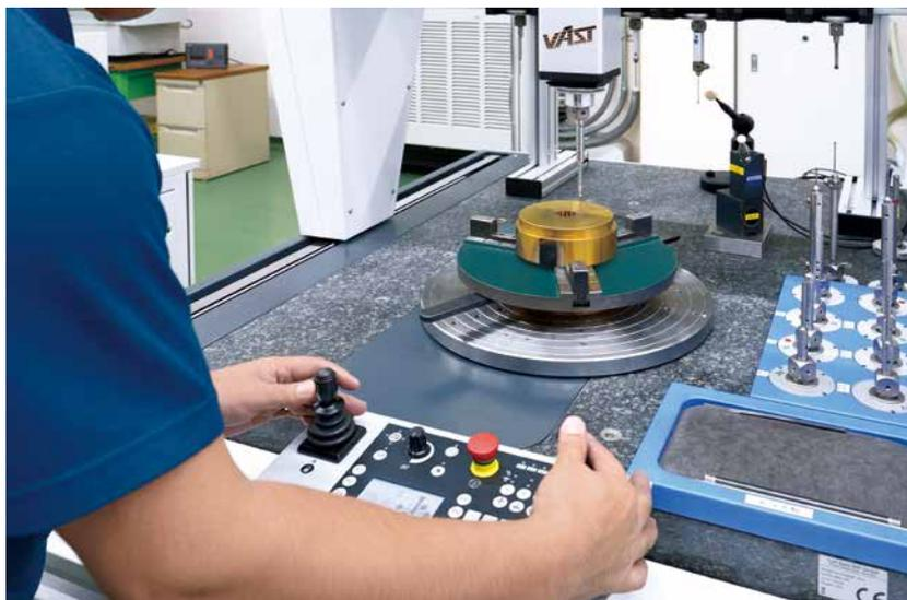
Le matrici prodotte con le macchine per l'elettroerosione sono poi controllate con dei dispositivi per la misurazione delle coordinate.
