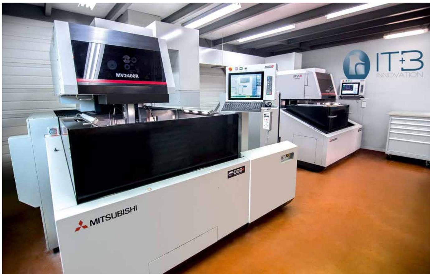
Le macchine MV1200R e MV2400R della ITB Innovation sono tenute in una stanza ad aria condizionata per garantire la massima precisione possibile.
