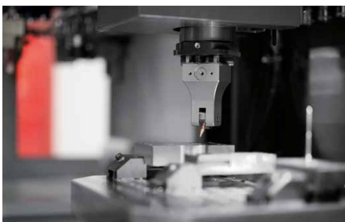
Dimostrazione sulla materozza di una macchina per l'elettroerosione a tuffo
