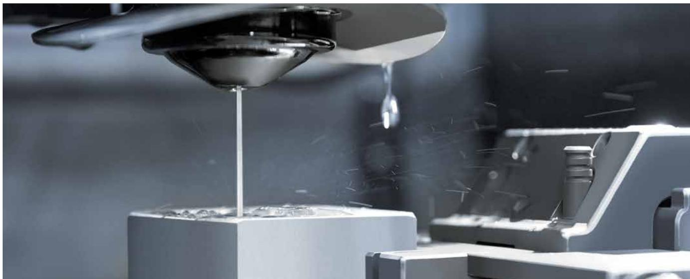
La macchina per l'elettroerosione a filo MV1200S di Mitsubishi Electric si è rivelata preziosa nella lavorazione di piccoli pezzi di precisione per stampanti e macchine numeratrici.
