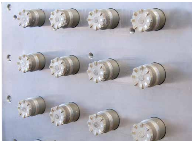
L'injecteur à canal chauffant inventé par Sismolding pour éliminer les carottes coûteuses et volumineuses
