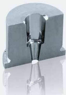
Matrice fabbricata e rifinita tramite elettroerosione, sezionata per verifiche di controllo.
