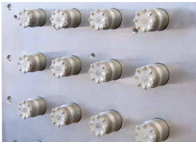
Iniettore a canale caldo inventato da Sismolding per eliminare costose e ingombranti materozze.
