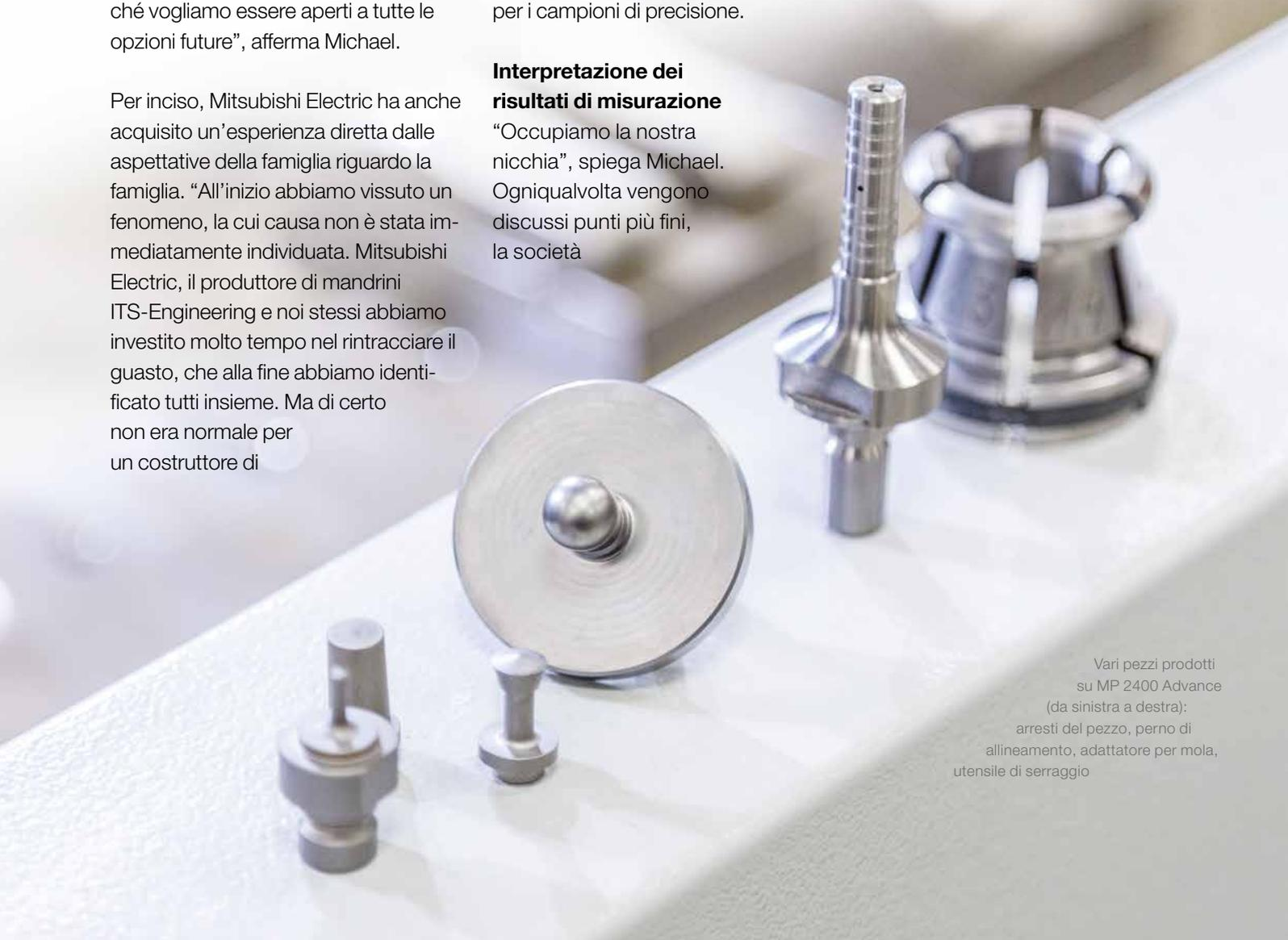
Vari pezzi prodotti su MP 2400 Advance (da sinistra a destra): arresti del pezzo, perno di allineamento, adattatore per mola, utensile di serraggio
