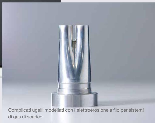
Complicati ugelli modellati con l'elettroerosione a filo per sistemi di gas di scarico
