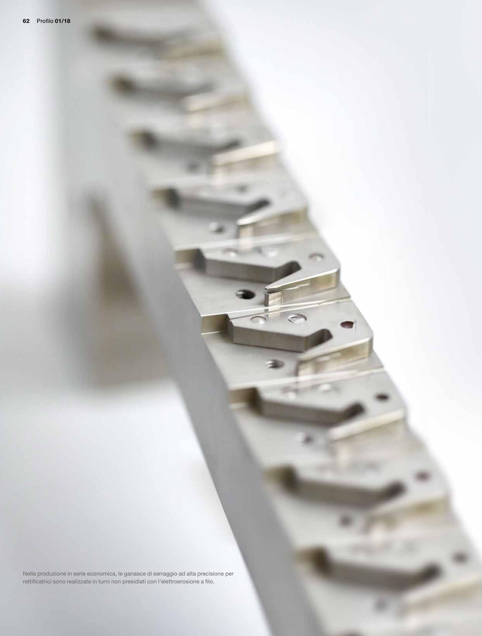
Nella produzione in serie economica, le ganasce di serraggio ad alta precisione per rettificatrici sono realizzate in turni non presidiati con l'elettroerosione a filo.
