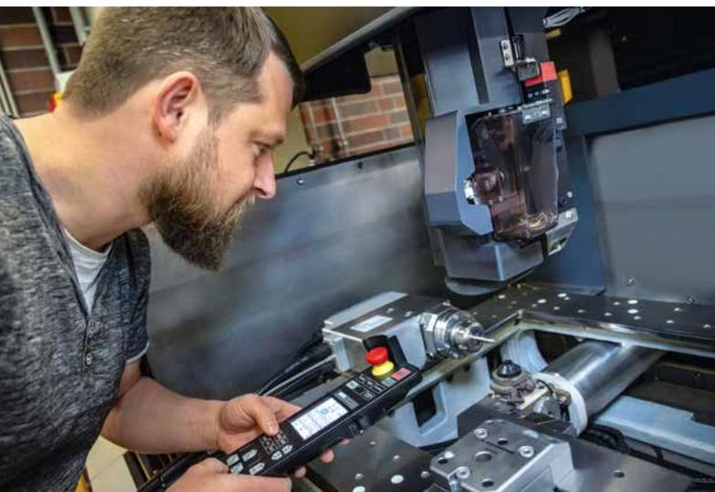
Auch neue Technologien wie das Dreherodieren werden in der Werkstatt am Institut für Experimentalphysik eingesetzt, um den ständig steigenden Anforderungen im Bereich der Bauteilkomplexität gerecht zu werden.
