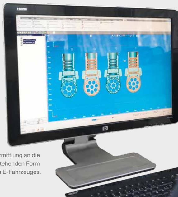
CAD/CAM-Aufbereitung der Schnittprogramme zur Übermittlung an die MV2400R. Bearbeitet werden hier die Einsätze einer entstehenden Form für Steckverbinder am Kabelbaum eines E-Fahrzeuges.
