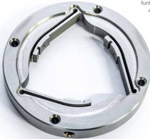
durch abtragende Verfahren bearbeiten lassen, einen hohen Stellwert ein. Vornehmlich handelt es sich dabei um hochpräzise Minibauteile, deren Bearbeitung kleinste Eckradien, sehr filigrane Konturen und hohe Oberflächengüten erfordern.“
