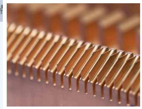
Drahtgeschnittene Elektrode mit dünnen Stegen, unter 32° schräg eingespannt
