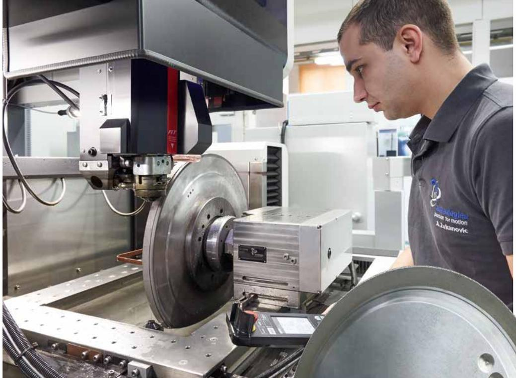
ITS-RS180 Rotationsspindel-Applikation: Profilieren und Abrichten von metallisch gebundenen Diamant- und CBN-Schleifscheiben
