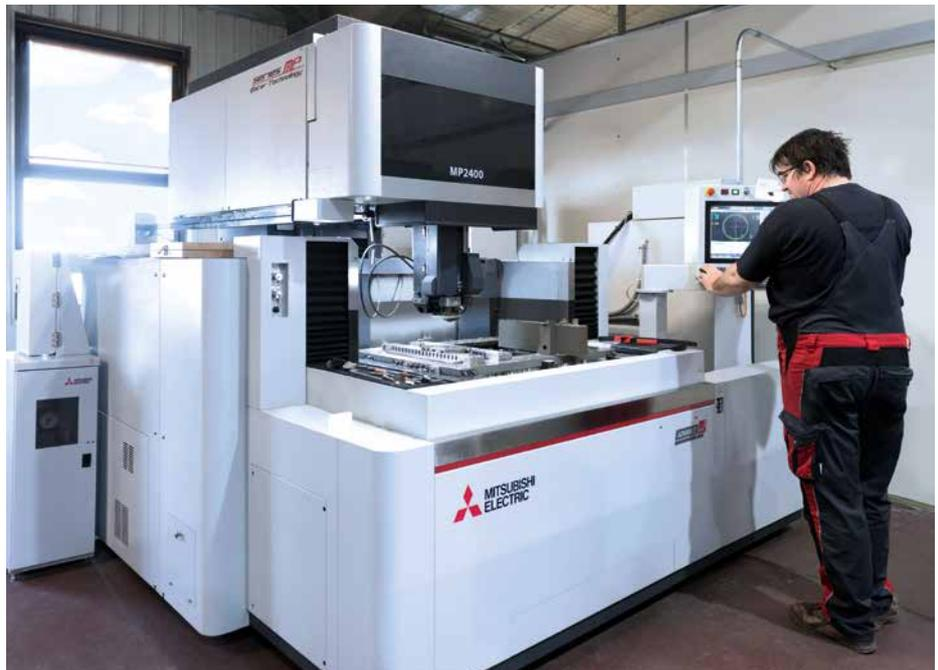
Neuester Maschinenzugang der Firma TROB: Die Drahterodiermaschine MP2400 der Firma Mitsubishi Electric
