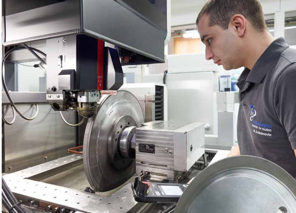
Utilisation de la broche rotative ITS-RSI80 : le profilage et le dressage de meules diamantées à liant métallique et en CBN.
