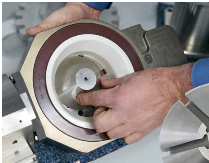
Utilisation de l'axe creux ITS-MA2-i-115 : l'usinage de rainures de mandrin
