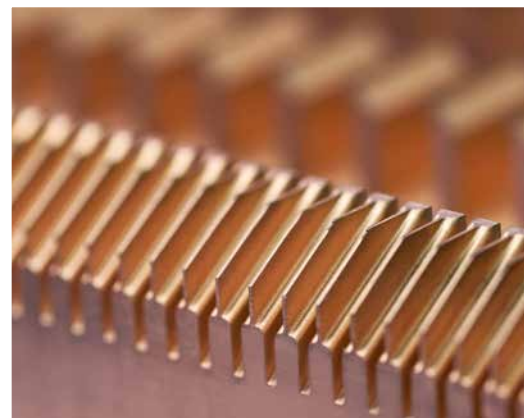
Une électrode usinée par électroérosion à fil avec des bobines fines, à un angle de 32°
