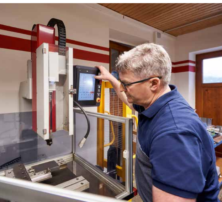
Un système de serrage continu – Une perceuse à trous de départ pour machine d'électroérosion à fil
