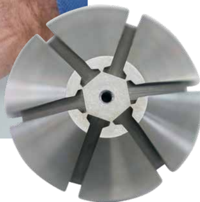
Utilisation de l'axe creux ITS-MA2-i-115 : l'usinage de rainures de mandrin
