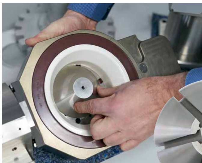
Applicazione dell’asse cavo ITS-MA2-i-115: lavorazione della scanalatura del mandrino
