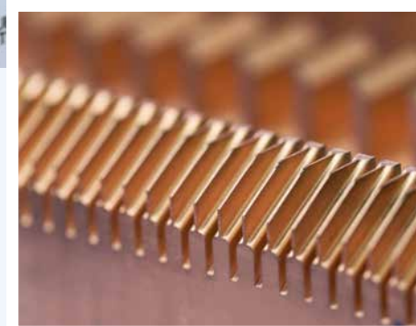
Elettrodo tagliato a filo con nastri sottili, bloccato con un angolo di 32°
