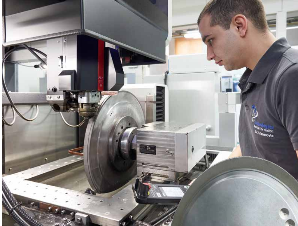
Applicazione del mandrino rotante ITS-RSI80: profilatura e rinvivatura di mole diamantate con metallo e CBN
