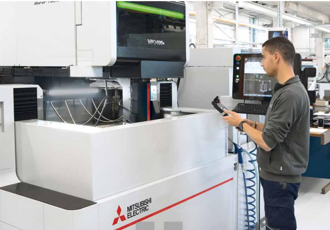
Begreiflich: die Steuerung mit großem Touchscreen und Bedienoberfläche – vergleichbar mit aktuellen Smartphones
