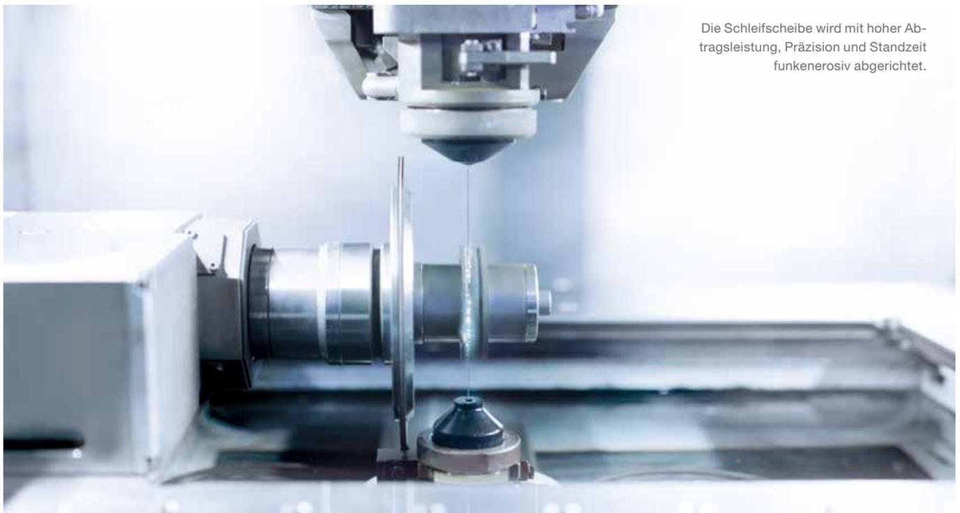
Die Schleifscheibe wird mit hoher Abtragsleistung, Präzision und Standzeit funkenerosiv abgerichtet.
