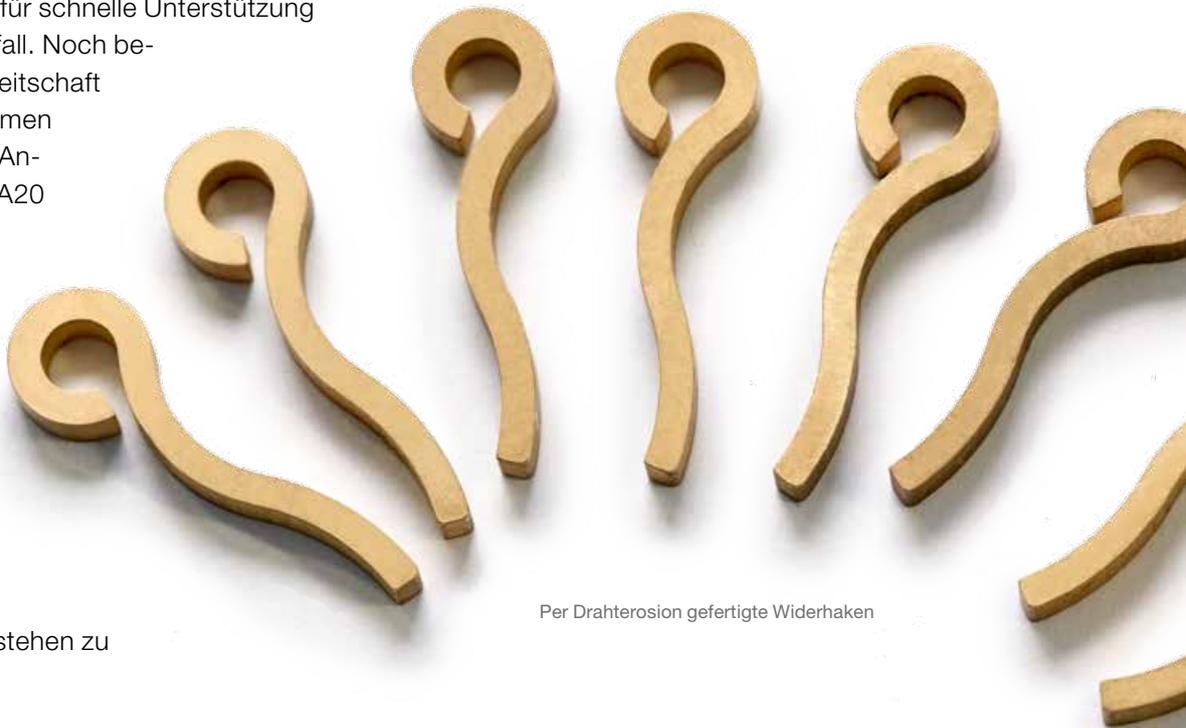
Per Drahterosion gefertigte Widerhaken
