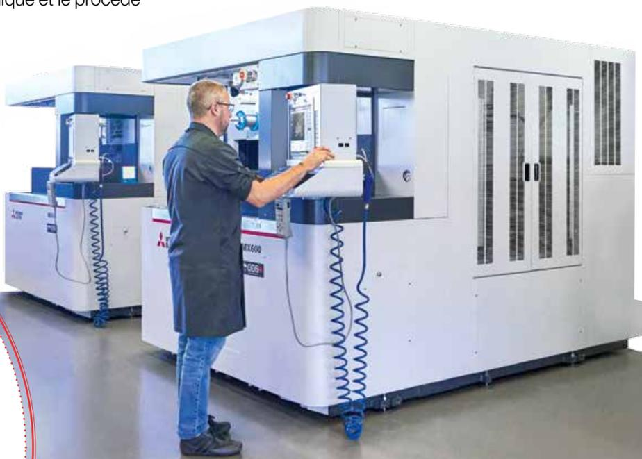
On peut observer quatre systèmes d'électroérosion Mitsubishi Electric dans l'atelier de production Hublot.
