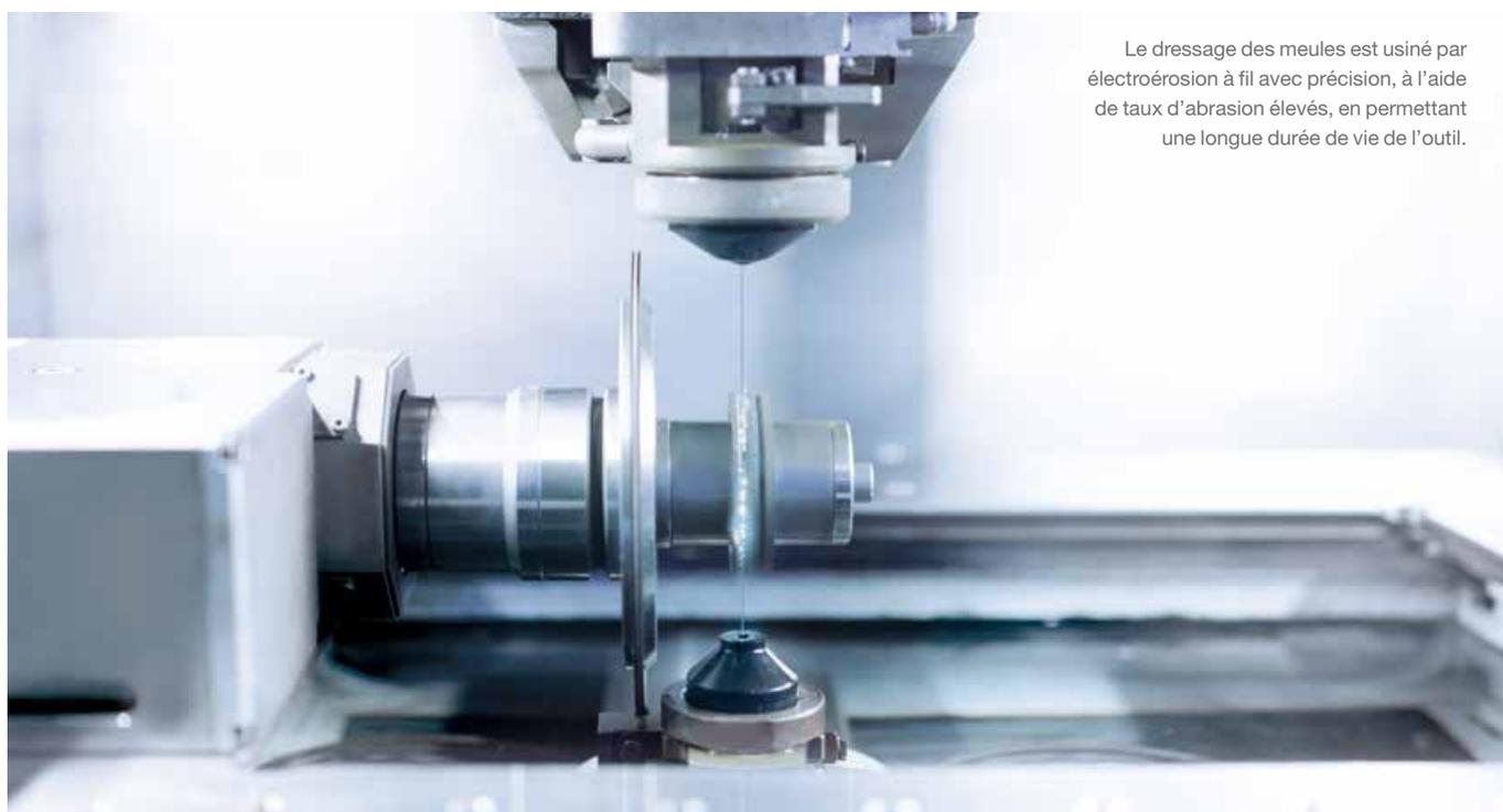
Le dressage des meules est usiné par électroérosion à fil avec précision, à l'aide de taux d'abrasion élevés, en permettant une longue durée de vie de l'outil.
