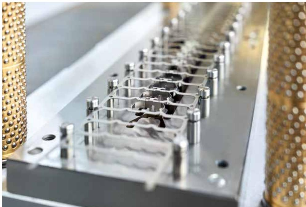
La production de pièces en tôle de haute qualité en grandes séries nécessite des matrices progressives complexes.
