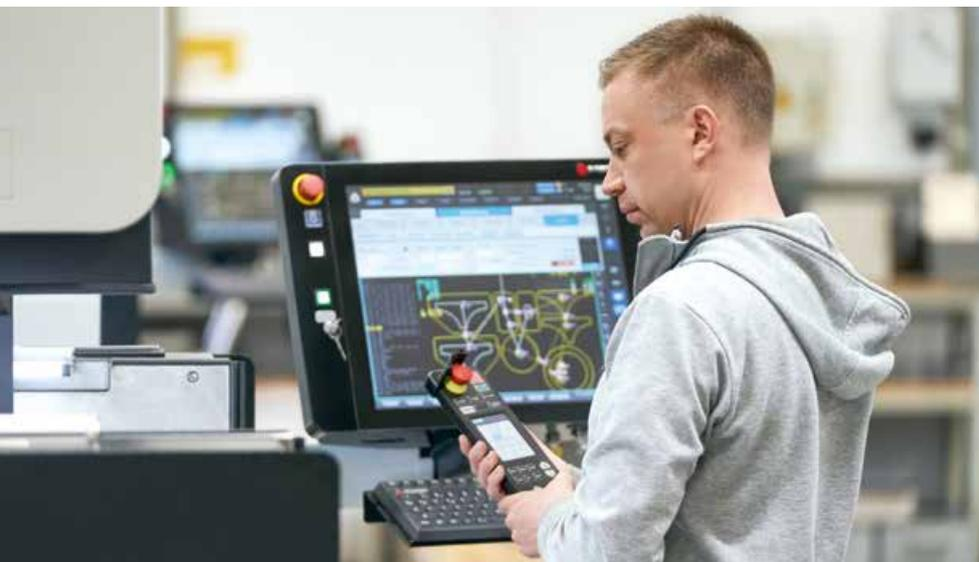
Il pannello di controllo mobile e l'impostazione dei parametri sullo schermo tattile assicurano una rapida configurazione.
