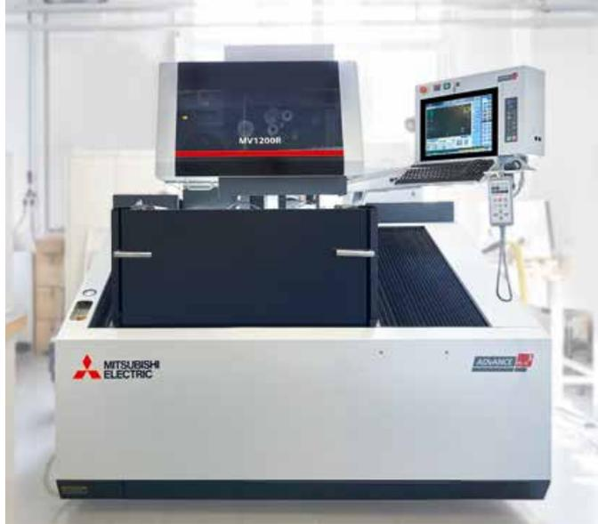
La macchina per elettroerosione a filo Mitsubishi Electric MV1200R in funzione a Boutroué dal 2016 consente la rifilettatura automatica anche in spazi ristretti.
