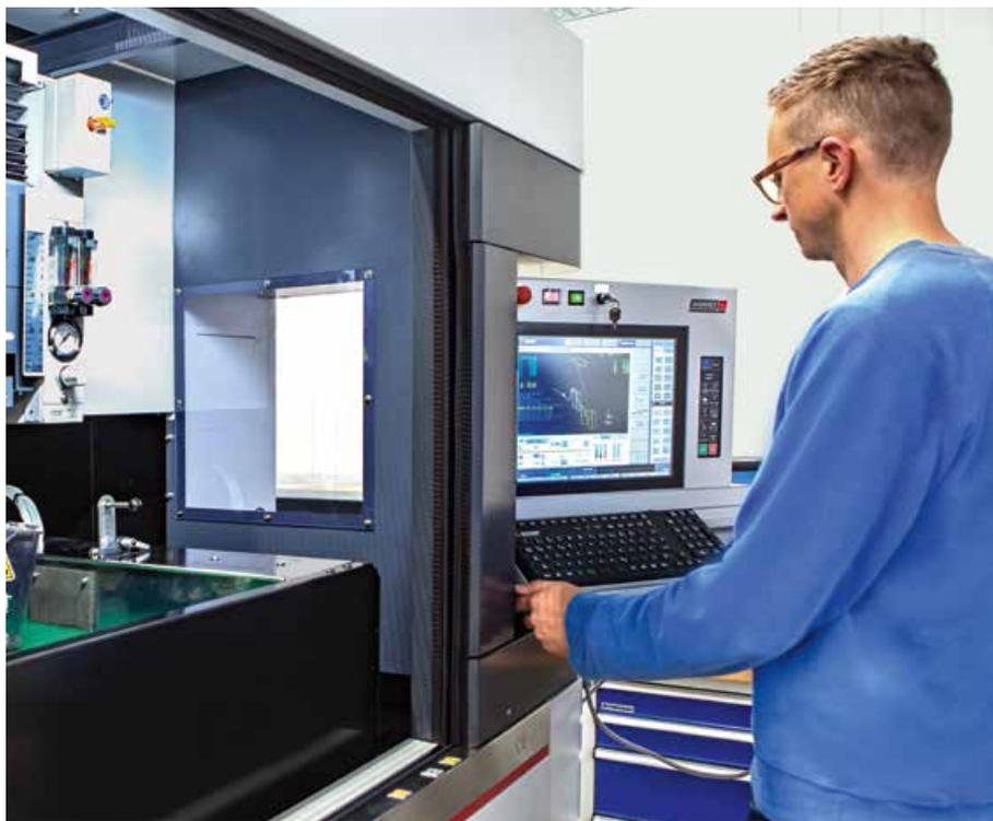
Grazie alla formazione di alta qualità e all'esperto supporto degli specialisti di Mitsubishi Electric, i lavoratori qualificati di Lehmann sono in grado di utilizzare il sistema ad elettroerosione a filo MX600 in modo flessibile e produttivo.
