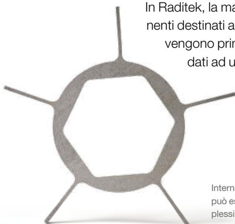
In Raditek, la maggior parte dei componenti destinati all'elettroerosione a filo vengono prima trasferiti in forma di dati ad un sistema CAD / CAM esterno da DCAM. Qui vengono generati i programmi NC per elettroerosione a filo.
