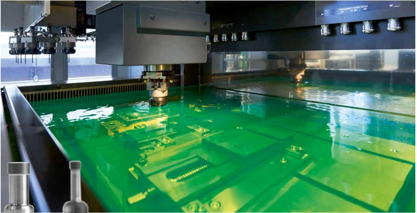
Die Mitsubishi Electric Senkerodieranlage EA12V Advance kommt für Aufgaben wie das Einsenken von Einlaufkonen in Düsenspitzen zum Einsatz.
