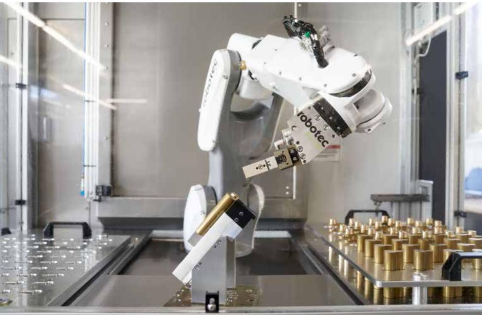
Die Schließzylinder werden in einer Roboterzelle vollautomatisch bearbeitet.
