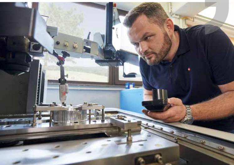
*Diese Drahterodiermaschine hat sich bei Vergleichstests als einzige herausgestellt, die unsere Forderungen nach hochgenauem Bearbeiten auf etwa 1 µm erfüllen kann.*
