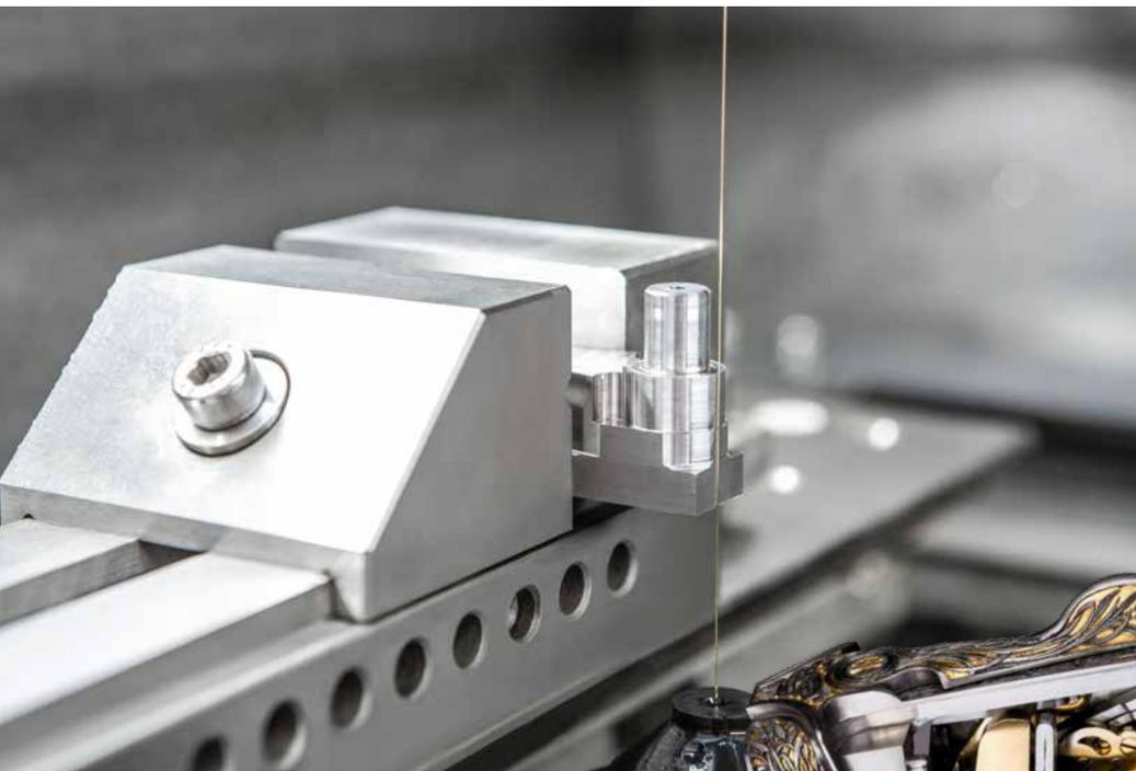
Auf der Drahterodiermaschine MV1200S NewGen werden die Rohlinge für den Verschluss und den Schlosskasten bearbeitet.
