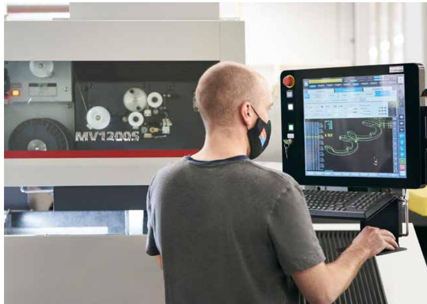
Kontrolle des gerade laufenden Programms zur Herstellung spezieller Sprengringe
