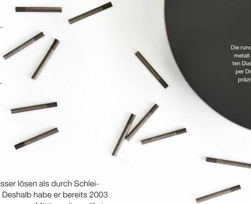
Die runde Scheibe besteht aus Hartmetall mit einer dicken aufgesinteren Diamantschicht. Daraus werden per Drahterosion die kleinen hochpräzisen Rohlinge für PKD Bohrer und Fräser geschnitten.
