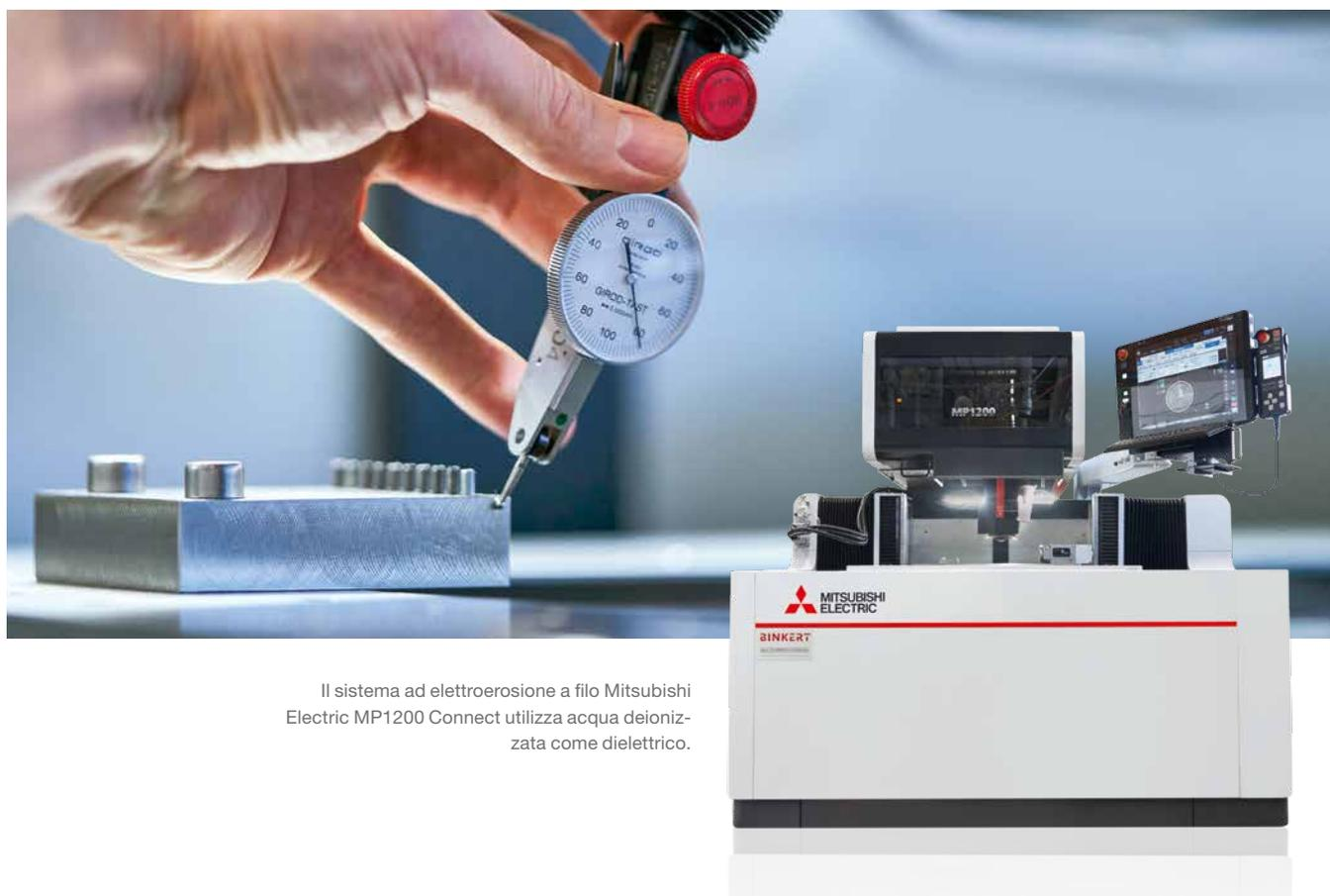
Il sistema ad elettroerosione a filo Mitsubishi Electric MP1200 Connect utilizza acqua deionizzata come dielettrico.
