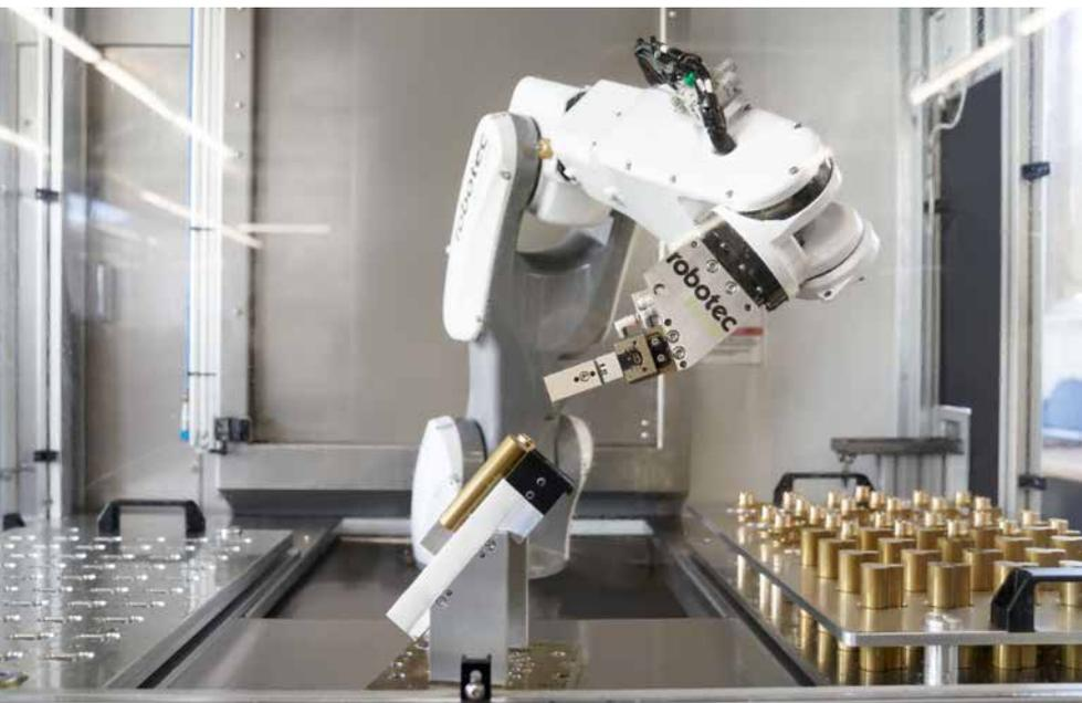
I cilindri della serratura vengono lavorati in modo completamente automatico in una cella robotizzata.
