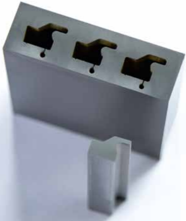
Beim Fertigen von Ersatzteilen für Stanz- und Schneidwerkzeuge, mit denen kleine Bauteile in der Medizintechnik und der Telekommunikation produziert werden, kommt es auf höchste Präzision an
