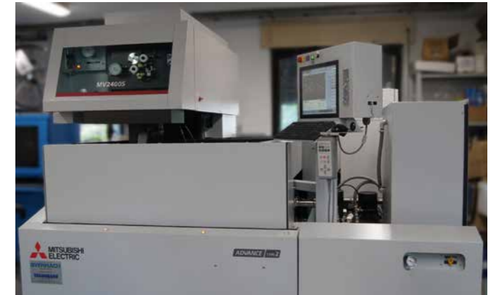
In der Werkstatt von Farina Marco wird die Mitsubishi Electric MV2400S für die Fertigung von Matrizen und Stempel für Entgratwerkzeuge eingesetzt.
