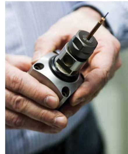
Mit der Vibrationseinheit MicroVibe300 senkt das Fraunhofer ICT-IMM kleine Strukturen sehr tief ein.
