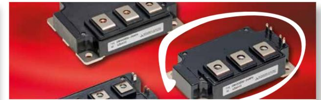
**Hybrid SiC Leistungshalbleiterteile für Anwendungen mit hohen Schaltfrequenzen.**
