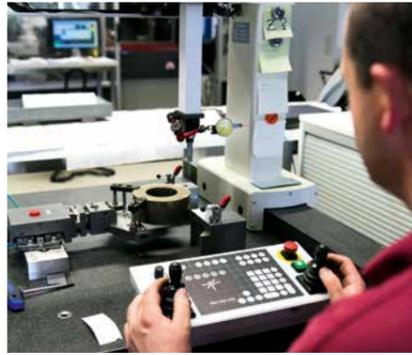
Externe Vermessung des eingespannten Werkstücks.
