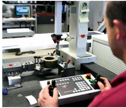
Mesure externe de la pièce serrée.
