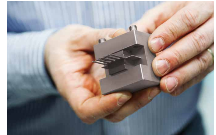
Même les « plus grandes » électrodes – pour la micro-électroérosion – ont des avantages.
