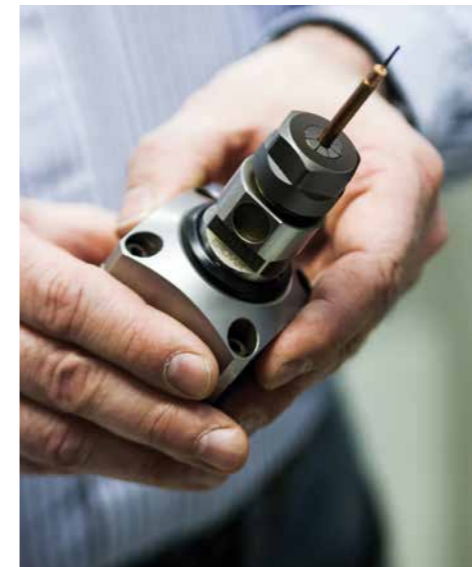
Grâce à l'unité de vibration MicroVibe300, le groupe Fraunhofer ICT-IMM peut fraiser des petites structures à une grande profondeur.
