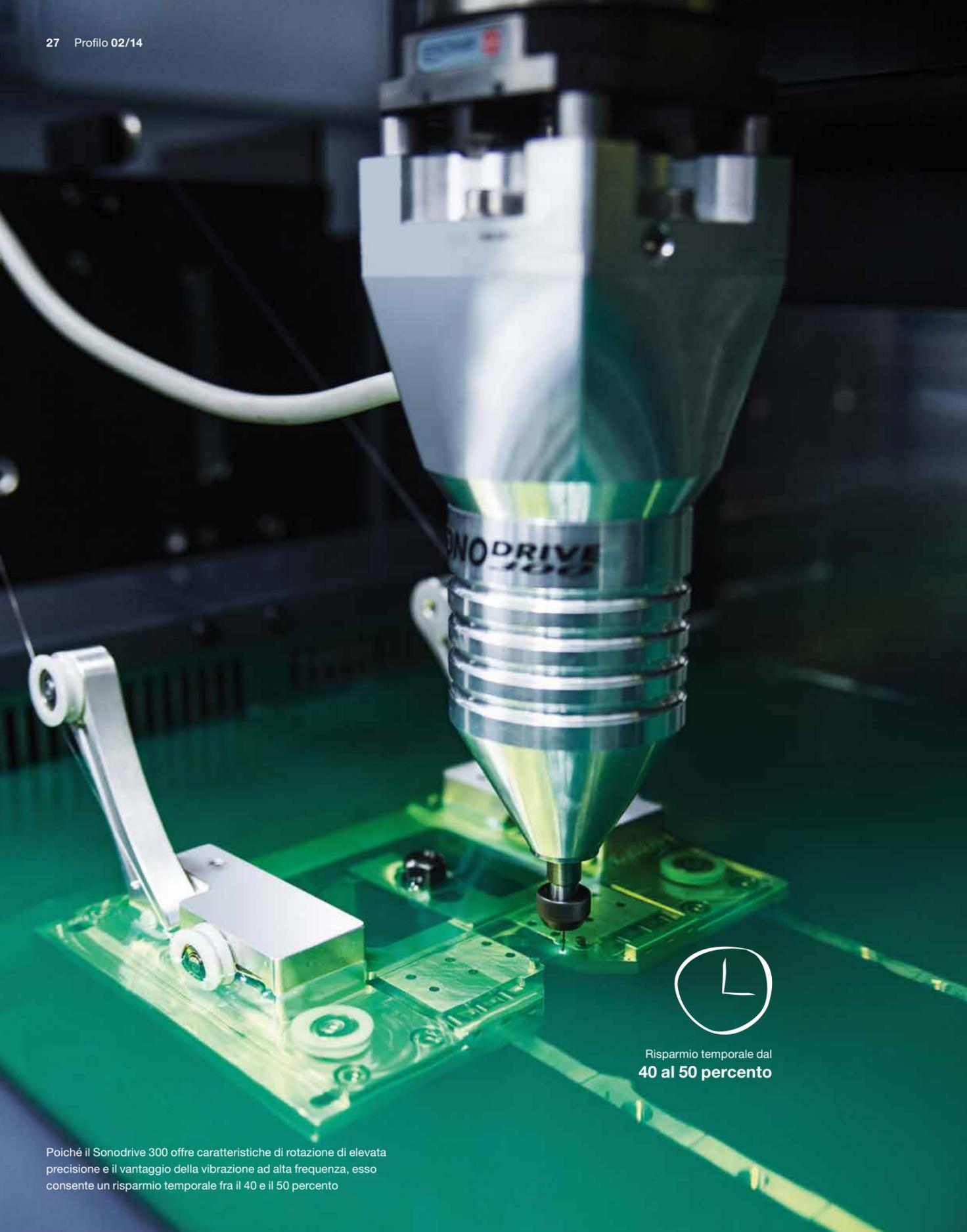
Poiché il Sonodrive 300 offre caratteristiche di rotazione di elevata precisione e il vantaggio della vibrazione ad alta frequenza, esso consente un risparmio temporale fra il 40 e il 50 per cento
