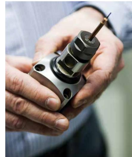
Con l'unità a vibrazione MicroVibe300, il Fraunhofer ICT-IMM può punzonare piccole strutture molto in profondità.
